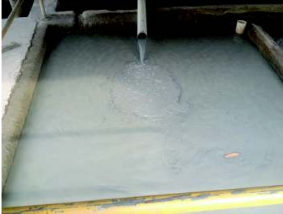
FIGURA 7. Tanques de acumulación de relave de Cianuración.
