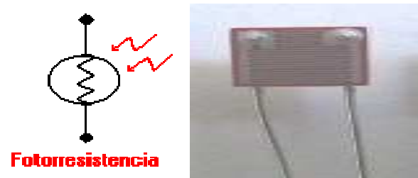
Figura 1.4. Símbolo y forma física de una LDR [5]
