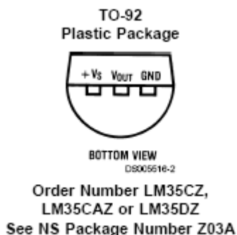
Figura 1.16. Sensor de temperatura LM35 [DATASHHET Anexo 5.1]
