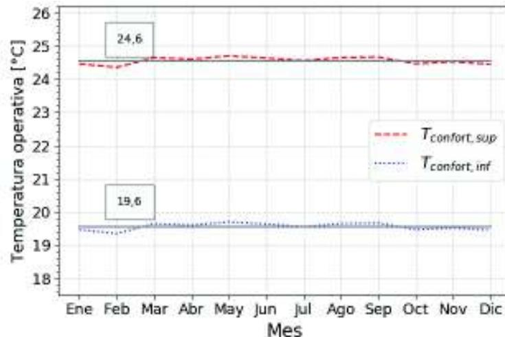
Figura 2.2. Rango de temperatura de confort adaptativo con un 90% de aceptación para Quito.
