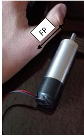
Figura 60. Motorreductor FAULHABER junto al pulgar. FP=0.038 m. (Fuente: Propia)
