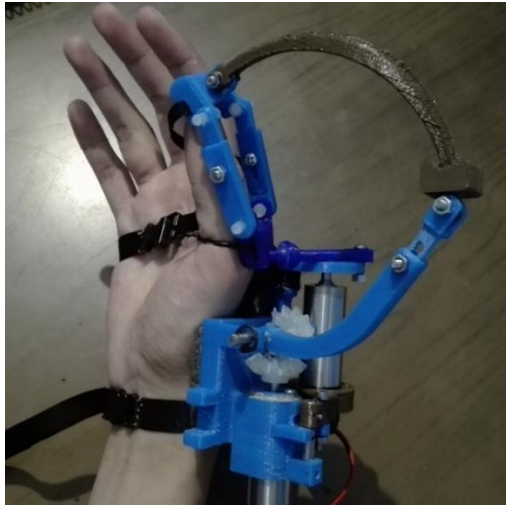
Figura 67. Mecanismo para obtener los movimientos propuestos por el exoesqueleto (Fuente: Propia)
