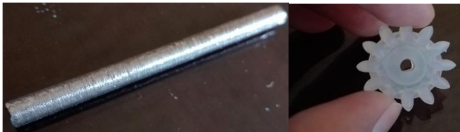
Figura 59. Eje de transmisión en AISI 1018 y engrane cónico en resina durable. (Fuente: Propia)
