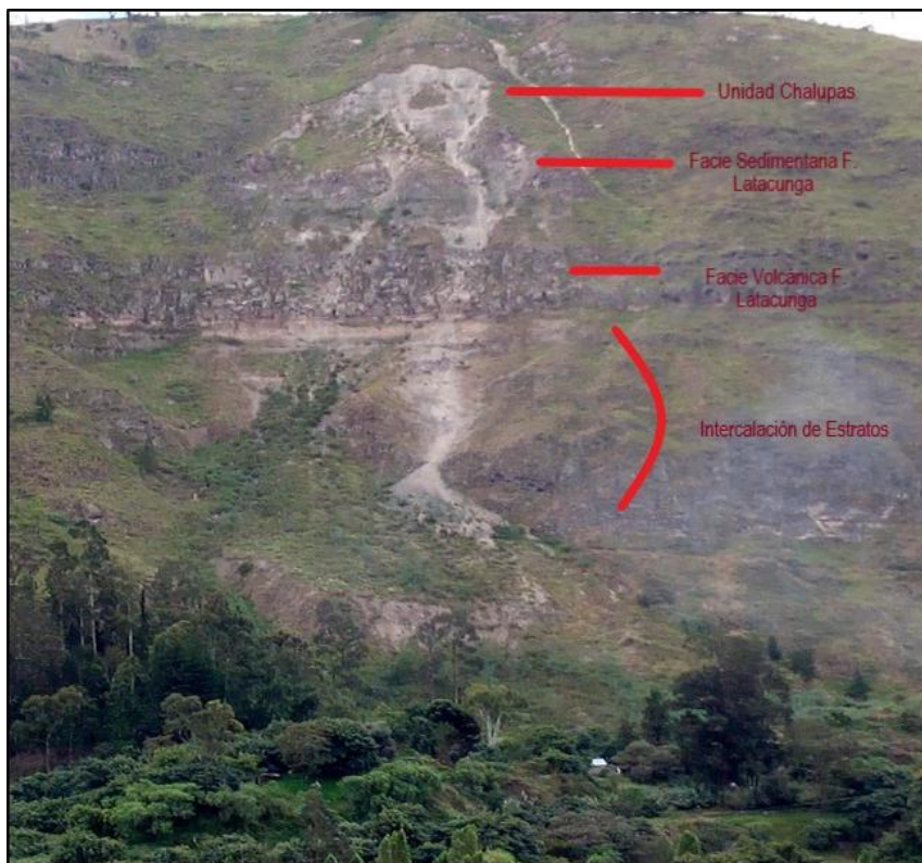
Figura 22 Identificación de las unidades que conforman la Formación Latacunga. Fotografía tomada en la carretera Izamba-Quillán La Playa por Sebastián Bombón.
