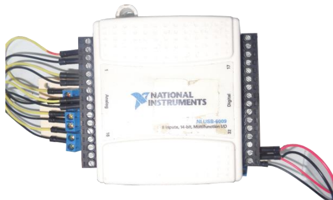
Figura 2.34. Tarjeta NI USB-6009 (Fuente: Propia)
