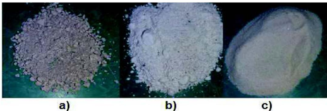
**Figura 3.6.** Presencia de impurezas de los minerales arcillosos seleccionados: a) AR-MO-17-01 b) FE-BO-17-02 y c) SI-NP-17-02
