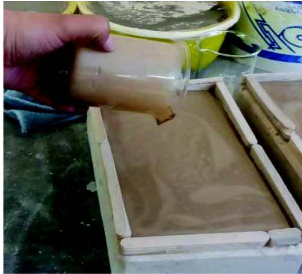
**Figura 3.10.** Formación de pasta en moldes de yeso-parte 1
