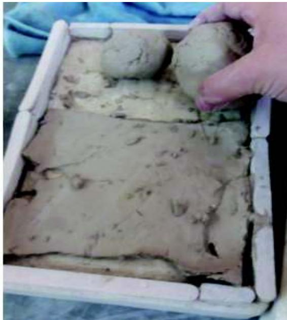
**Figura 3.11.** Formación de pasta en moldes de yeso-parte 2
