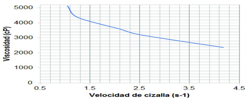
**Figura 3.8.** Curva de tixotropía para la barbotina comercial
