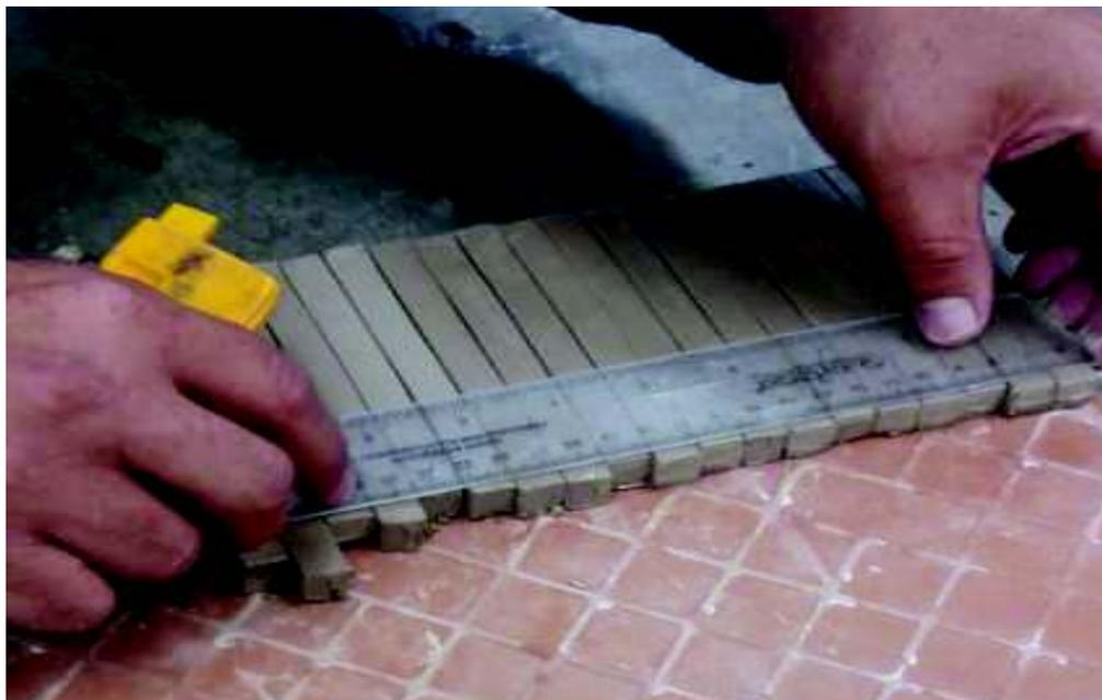
**Figura 3.14.** Medición de la marca de 10 cm sobre las probetas
