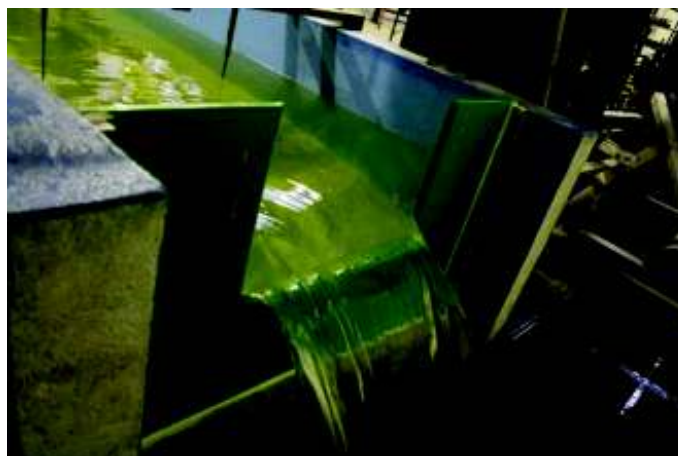
Fotografía No. 3.8: Vertedero rectangular de pared delgada con contracciones laterales en funcionamiento
