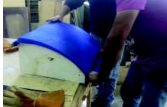
Fotografía No. 11: Perfil curvo moldeado
