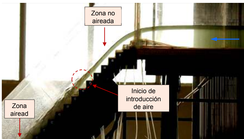
Fotografía No. 4.14: Prueba 2. Vista lateral izquierda del inicio de la rápida escalonada, se puede observar el comienzo de la introducción de aire
