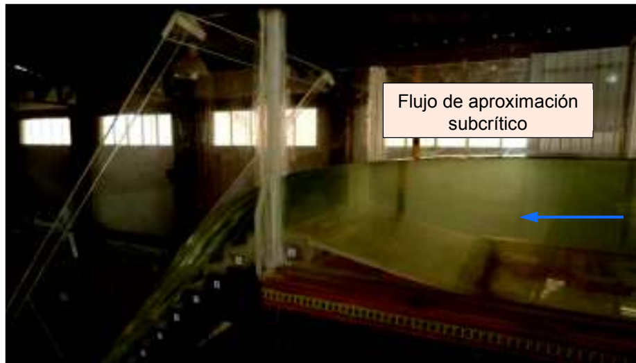
Fotografía No. 4.25: Prueba 4. Vista lateral izquierda del tramo de aproximación hacia la rápida escalonada
