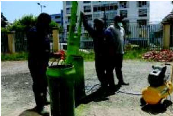
Fotografía No. 21: Fabricación y pintura del vertedero rectangular de pared delgada con contracciones laterales
