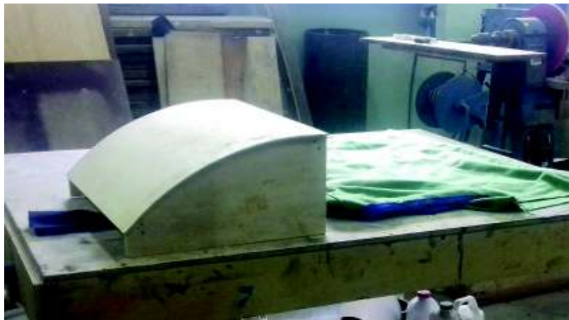
Fotografía No. 9: Horno para colocar piezas de acrílico, permite que adquieran una temperatura adecuada para su moldeo
