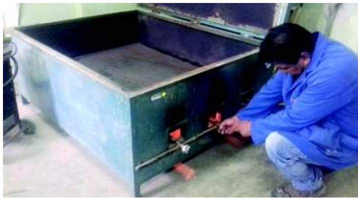
Fotografía No. 9: Horno para colocar piezas de acrílico, permite que adquieran una temperatura adecuada para su moldeo
