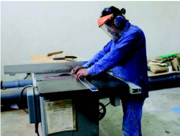
Fotografía No. 12: Elaboración de las piezas de acrílico que conforman cada una de las partes de la instalación experimental
