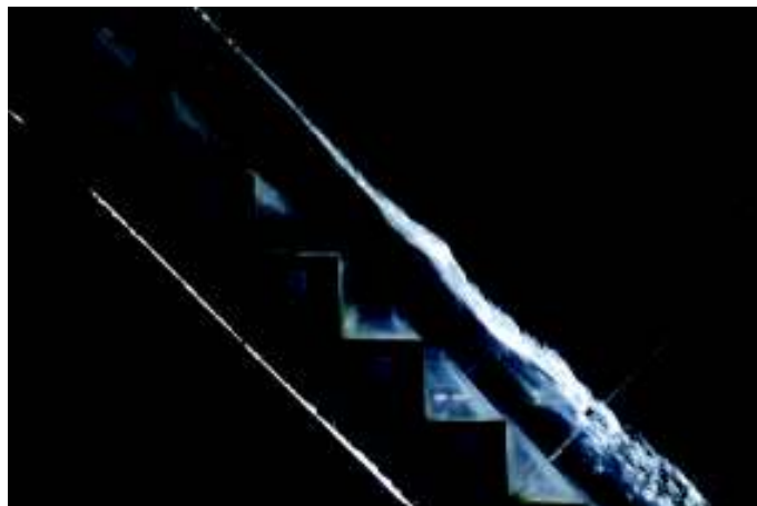
Fotografía No. 2.2: Flujo parcialmente aireado
