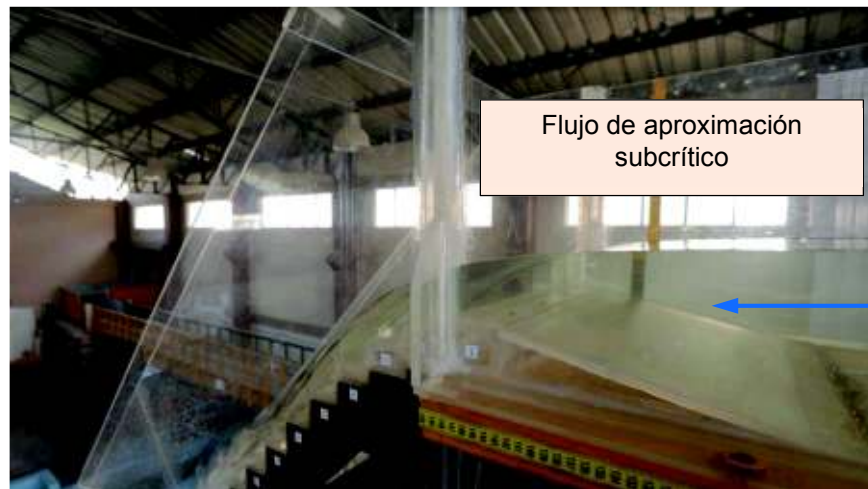
Fotografía No. 4.7: Prueba 1. Vista lateral izquierda del tramo de aproximación hacia la rápida escalonada
