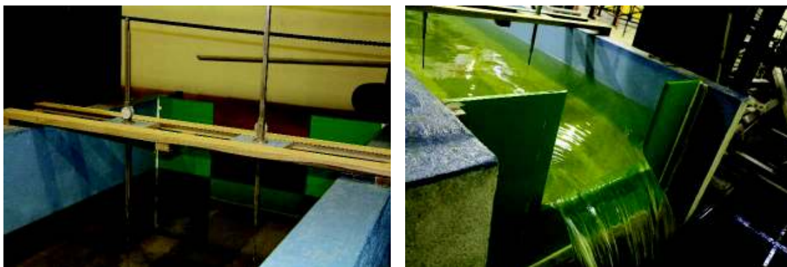
Fotografía No. 3.13: Aforo volumétrico para vertedero rectangular de pared delgada, medición de cargas sobre el vertedero
