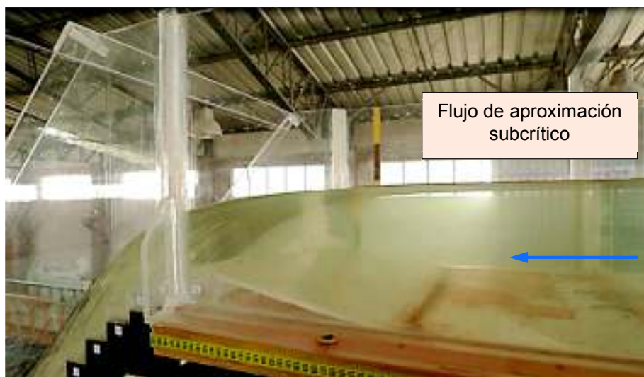
Fotografía No. 4.19: Prueba 3. Vista lateral izquierda del tramo de aproximación hacia la rápida escalonada
