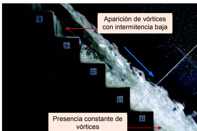
Fotografía No. 4.53: Prueba 2. Vista lateral derecha. Identificación de la presencia de vórtices
