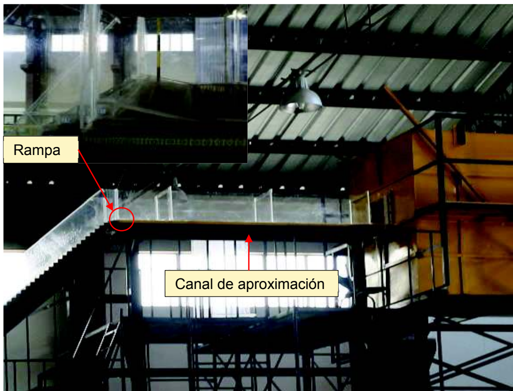
Fotografía No. 3.3: Tramo de aproximación construido en acrílico
