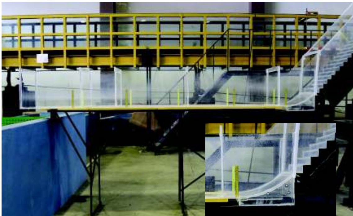
Fotografía No. 3.6: Canal de salida construido en acrílico
