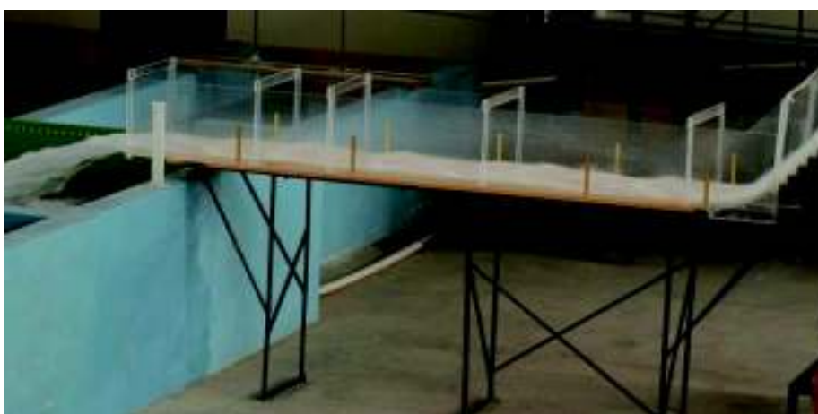
Fotografía No. 3.16: Canal de salida al pie de la rápida escalonada
