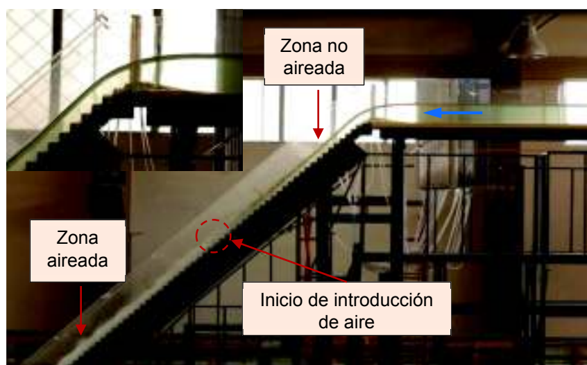
Fotografía No. 4.32: Prueba 5. Vista lateral izquierda del inicio de la rápida escalonada, se puede observar el comienzo de la introducción de aire
