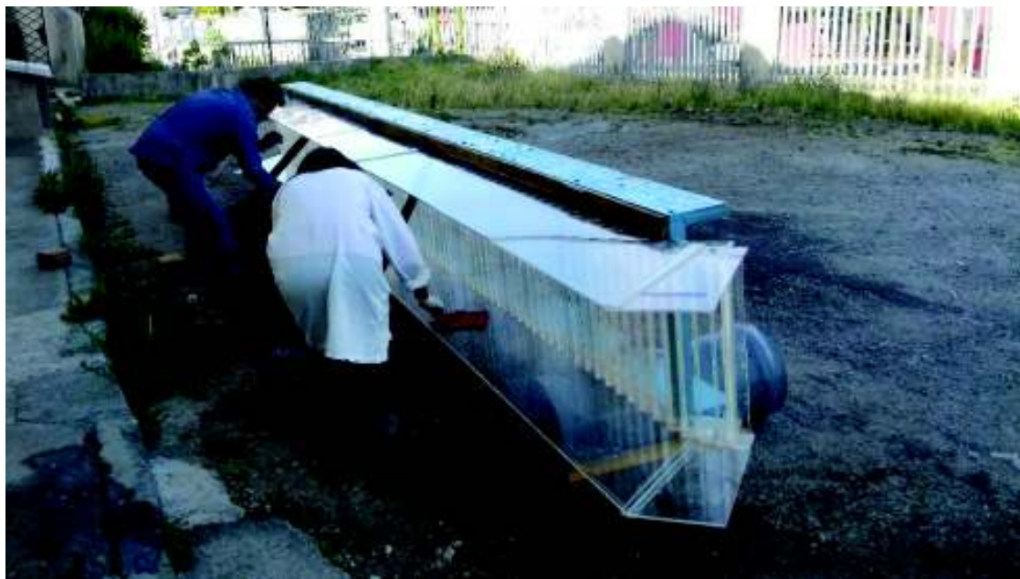
Fotografía No. 14: Limpieza de la rápida escalonada existente en el Laboratorio del CIERHI
