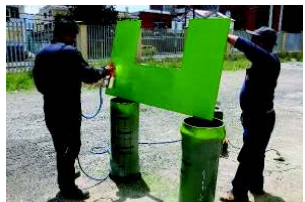
Fotografía No. 21: Fabricación y pintura del vertedero rectangular de pared delgada con contracciones laterales
