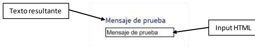
Figura 1.12. Ejemplo del resultado HTML de usar directiva v-model de Vue
