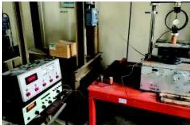
Fotografía 2 Ensayo de compresión de cilindro de mampuesto
