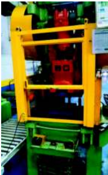
Figura 1.4. Instalación de una pantalla de seguridad (SIS DEVICES, 2017)
