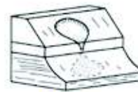
Golpe de arena
