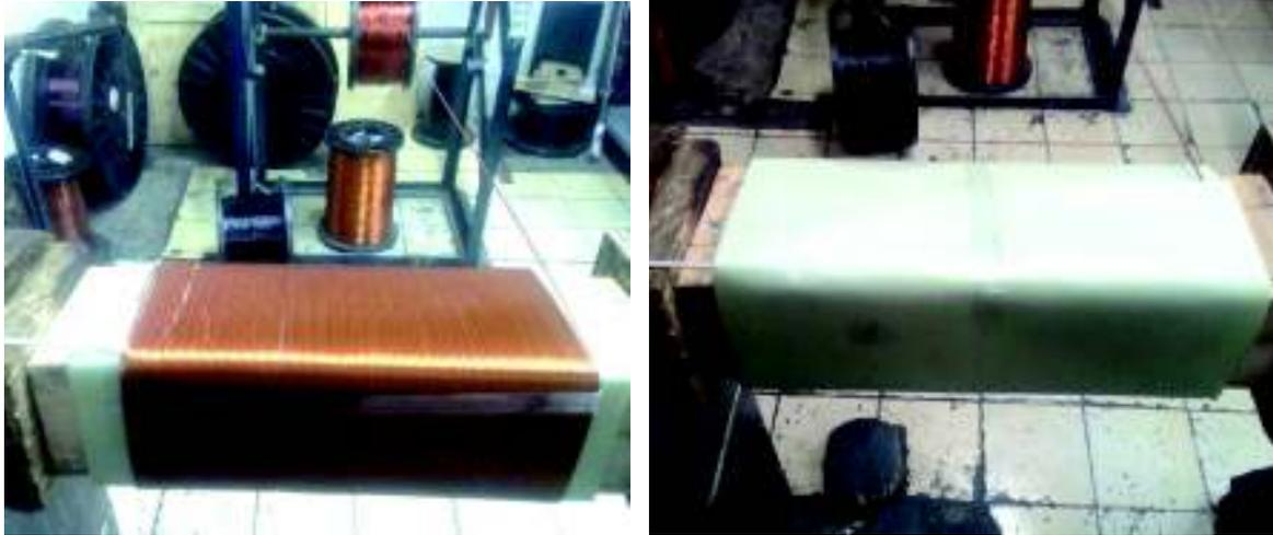
**Figura A4.5.** Arrollamiento de la bobina y colocación del aislamiento entre capas
