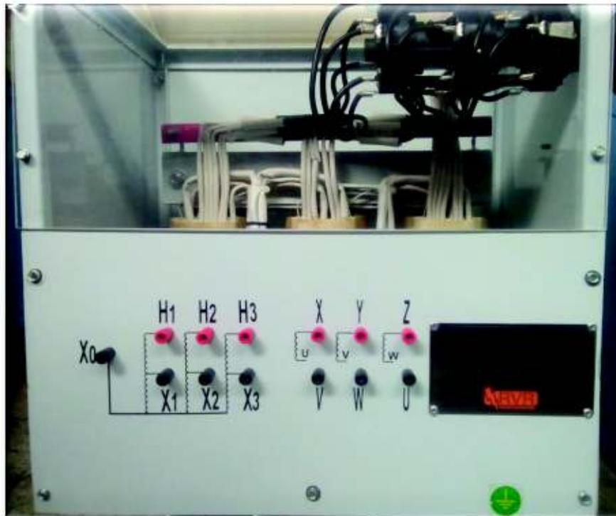
**Figura 3.12.** Aspecto final del autotransformador
