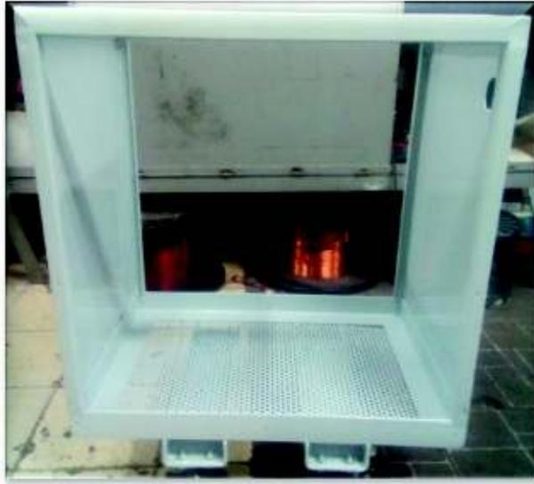
**Figura A4.10.** Caja metálica del autotransformador
