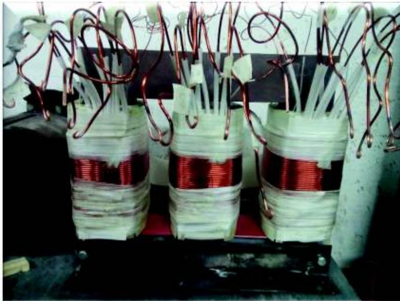
**Figura A4.8.** Bobinas montadas sobre el núcleo
