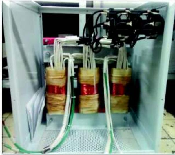
**Figura A4.11.** Montaje del autotransformador dentro de la caja y conexión del conmutador de taps
