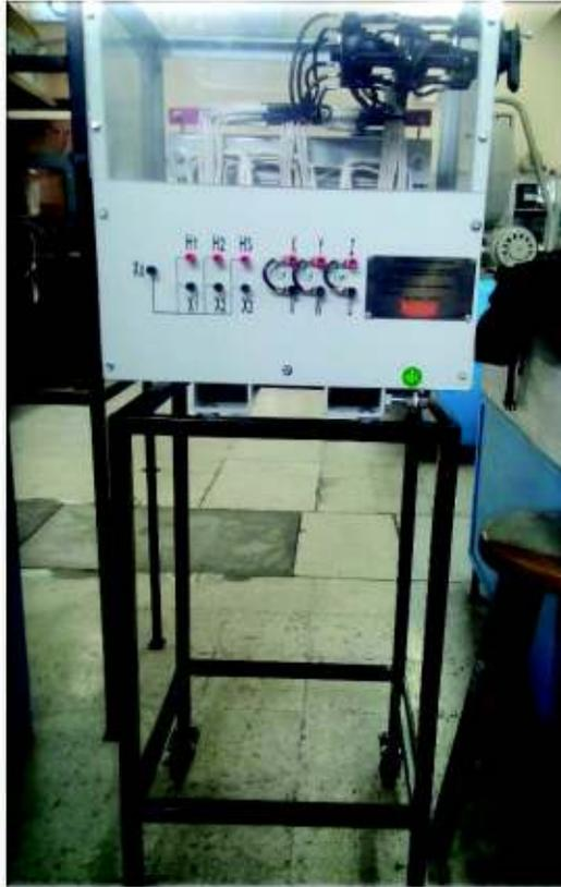
**Figura A4.14.** Montaje del autotransformador sobre el pedestal con garruchas
