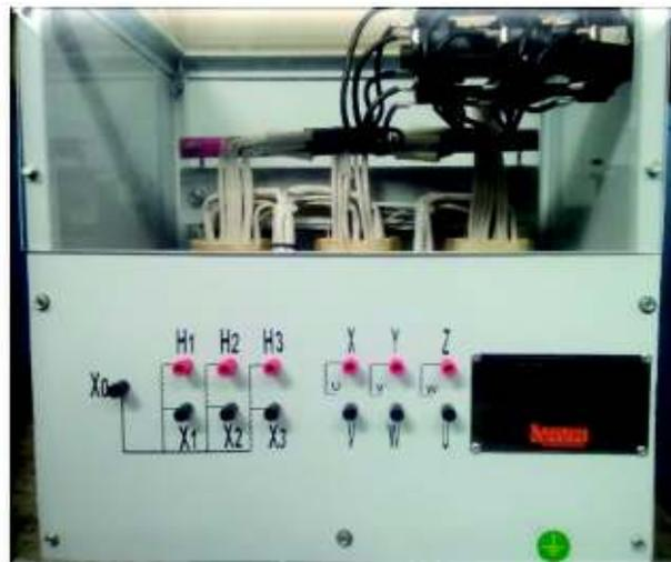
**Figura A4.13.** Etiquetado de borneras y colocación de placas de identificación
