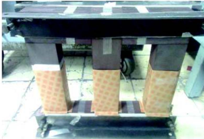
**Figura A4.3.** Prensado del núcleo y aislado para la prueba de vacío previa al diseño
