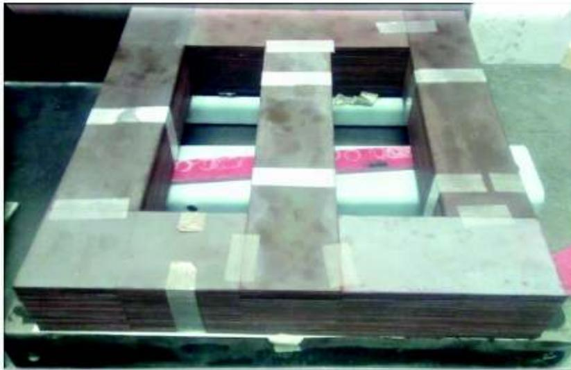
**Figura A4.2.** Aspecto del núcleo apilado
