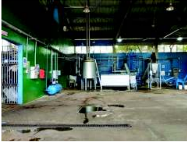
Figura IV. Incinerador para la elaboración de harina sangre con decomisos no patógenos. Sistema de Gestión actual. (FUEL & GUALOTUÑA, 2018).
