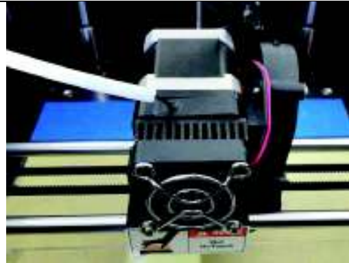
Alimentación del filamento al extrusor.
