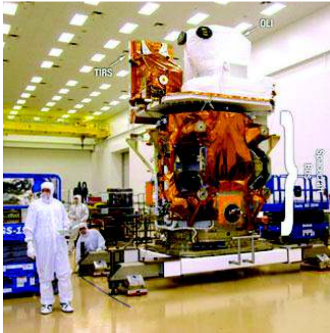
Figura 1.2: Los sensores OLI y TIRS montados en la plataforma LDCM (LANDSAT 8). TIRS fue recubierto con una capa múltiple dorada de aislamiento, y OLI fue aislado con una cobertura blanca de Tedlar.(USGS, 2018).
