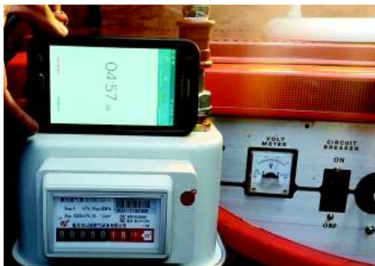
Figura 3.11. Prueba de medición del consumo de biogás (Fuente: Elaborado por autor, 2018)
