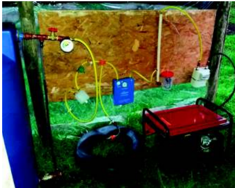
Figura 2.18. Ensamble de depósito de almacenamiento de biogás (Fuente: Elaborado por autor, 2018)
