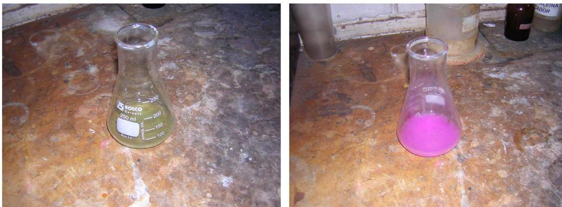
Figura 5.8: Determinación de la acidez de la tina de fosfato.
