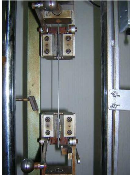
Figura 6.1: Probeta colocada en la máquina Zwick.
