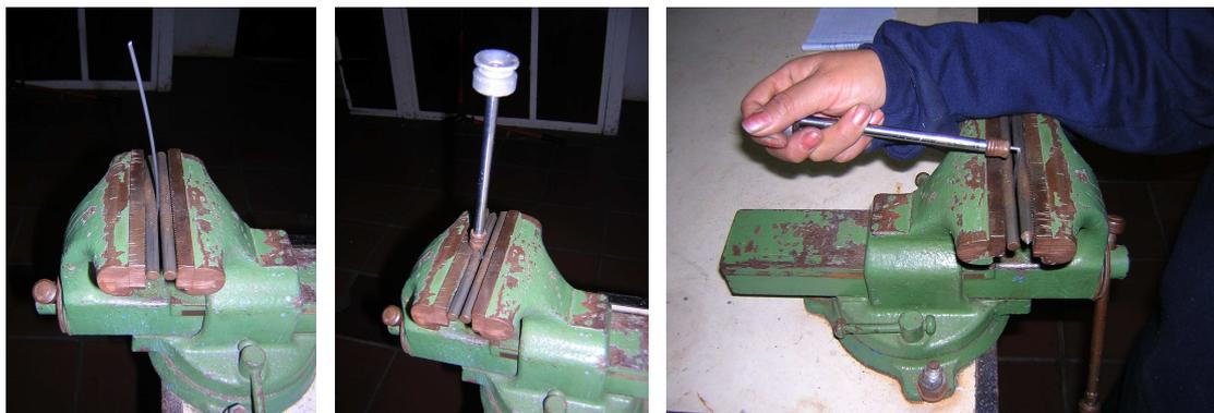
Figura 6.6: Ensayo de flexión.
