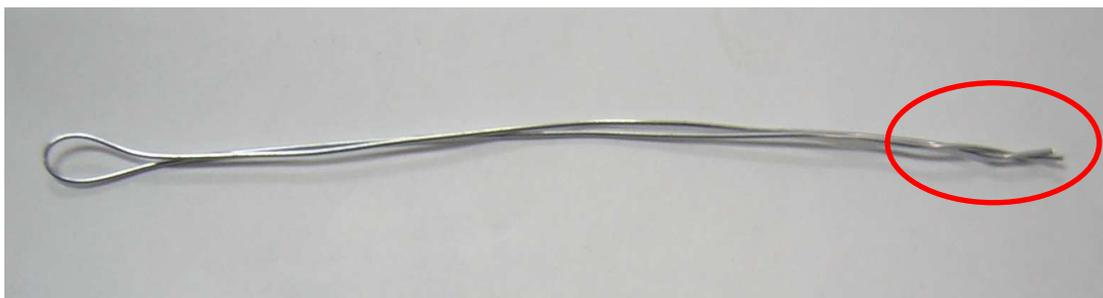
**Figura 6.9: Preparación de la probeta para el ensayo de capa de zinc.**
