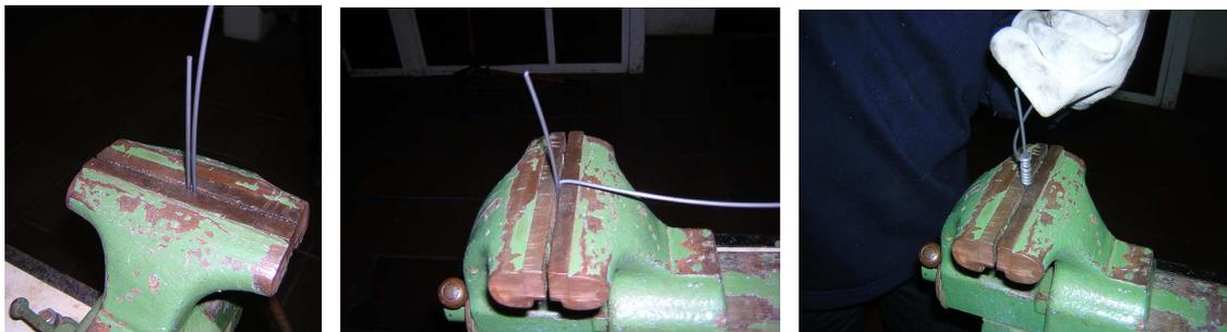
Figura 6.7: Ensayo de enrollado.
