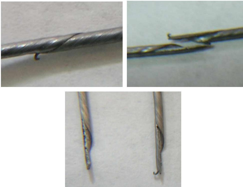
**Figura 6.5: Probeta con falla después del ensayo de torsión.**
