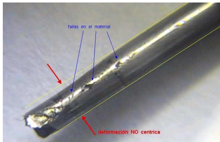
Figura 2.17: Fallas de un alambre que ha sufrido una deformación no céntrica.
