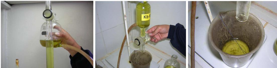
Figura 6.11: Retirada de la probeta de la bureta.
