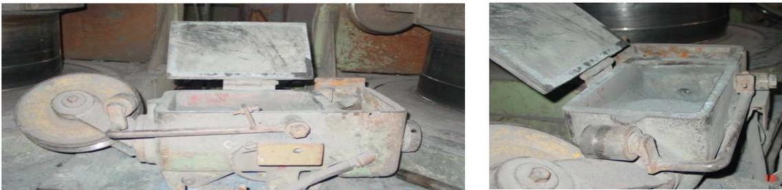
Figura 4.1: Jaboneras de las máquinas trefiladoras.
