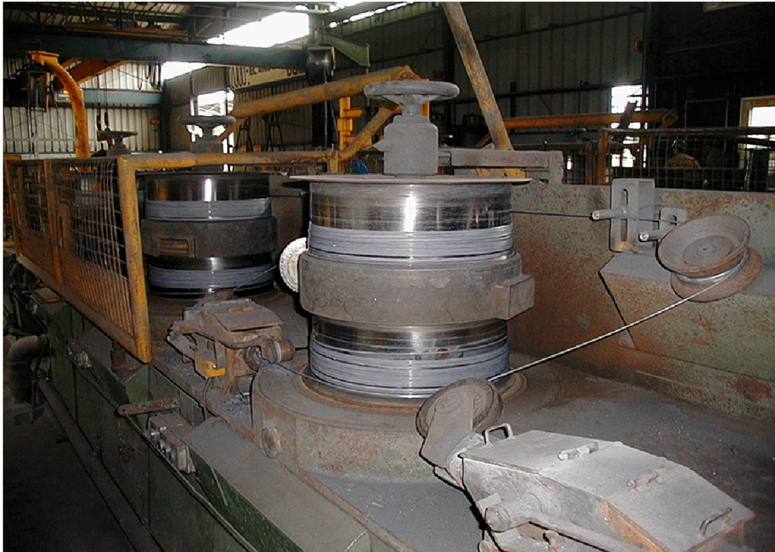
Figura 3.3: Máquina trefiladora con acumulación sin torsión.
