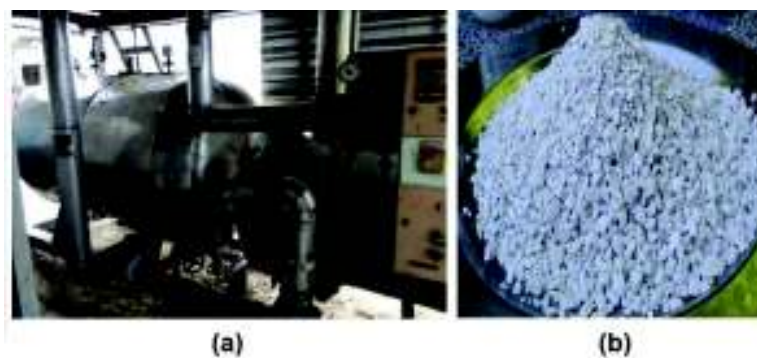
Figura 1.7. (a) Maquinaria para filtración, mediante tierra filtrante (célite). (b) Célide.
