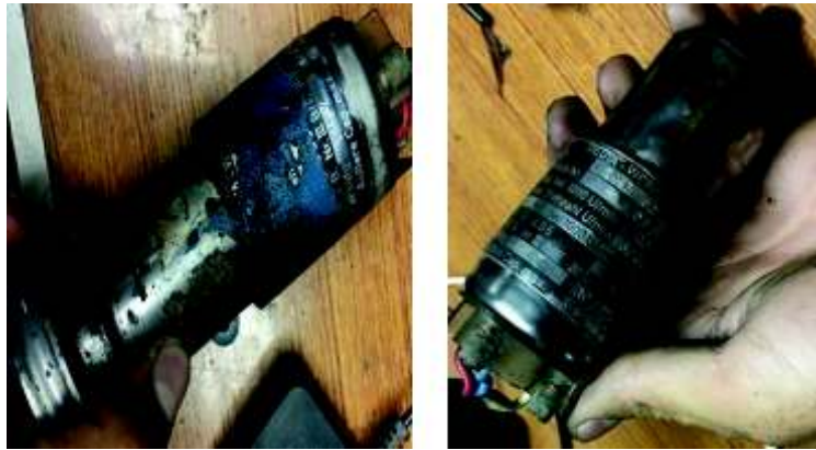
Figura 2.24. Tacogenerador para medición de velocidad.
