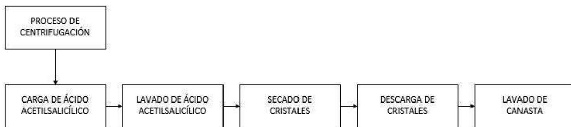
Figura 2.70. Arquitectura del proceso.
