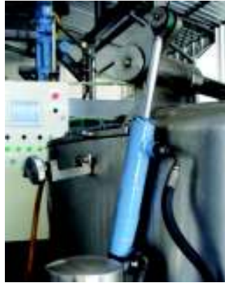
Figura 2.8. Cilindro de doble efecto (lado izquierdo) para apertura y cierre de la tapa.
