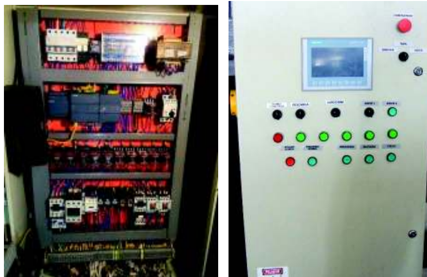
Figura 2.45. (a) Ubicación de los elementos y realización de conexiones. (b) Vista frontal del panel de operación.
