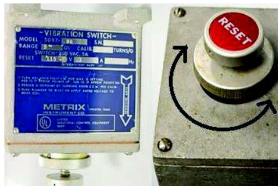
Figura 2.21. Switch de vibración, regulación y reset para el enclavamiento (Metrix Instrument CO) [12].
