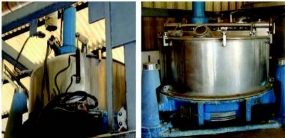
Figura 1.26. Estado de la centrifugadora, parte exterior
