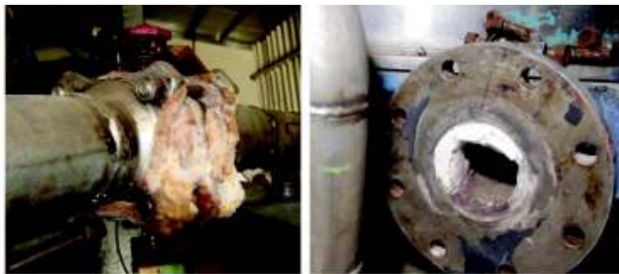
Figura 2.35. Resultados de la circulación de ácido acetilsalicílico a través de las tuberías y válvulas tipo globo.
