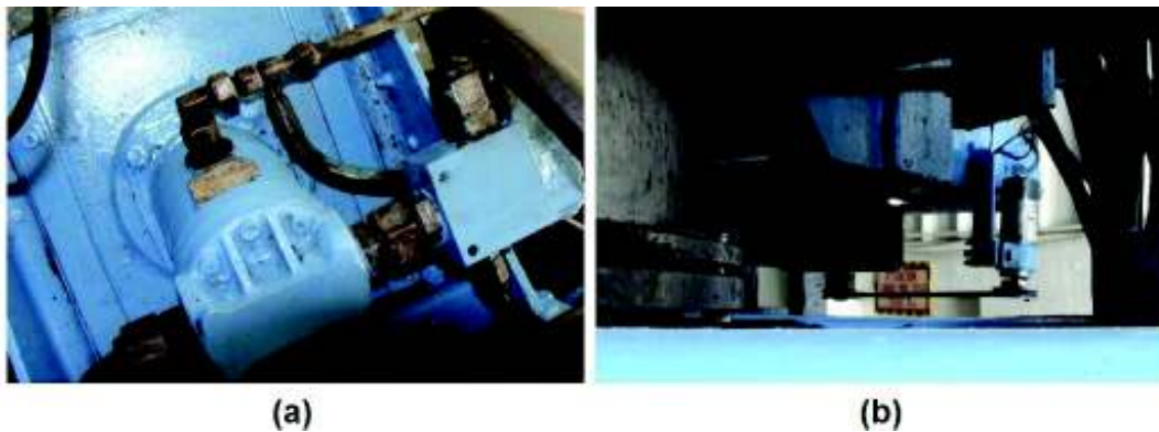
Figura 2.6. (a) Bomba de pistones axiales de la centrífuga, (b) Acople del eje de la bomba al eje de la canasta, mediante bandas.
