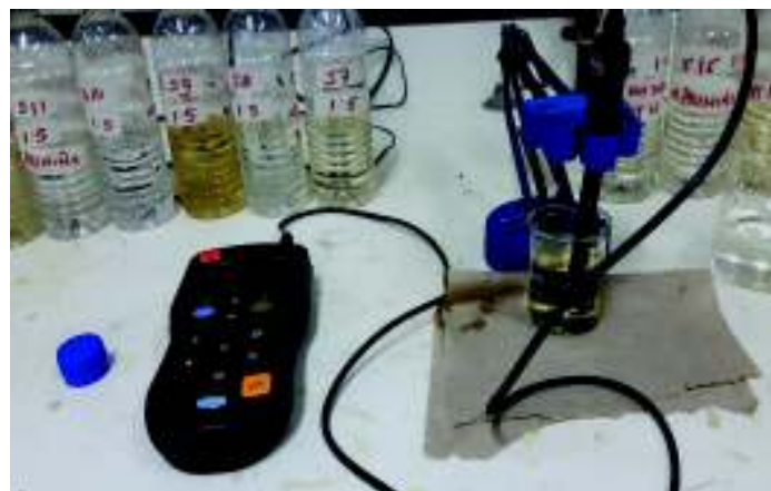
Multiparamétrico y sonda pH
