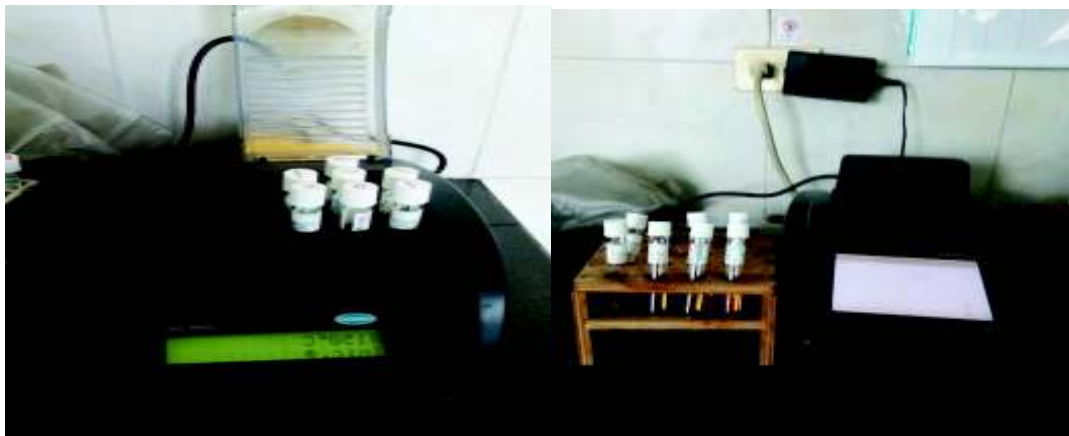
FIGURA 3.9 DIGESTOR HACH DRB 200 CON LOS VIALES DE DQO Y ESPECTROFOTRÓMETRO HACH DR 2700 CON LOS VIALES DE DQO.
