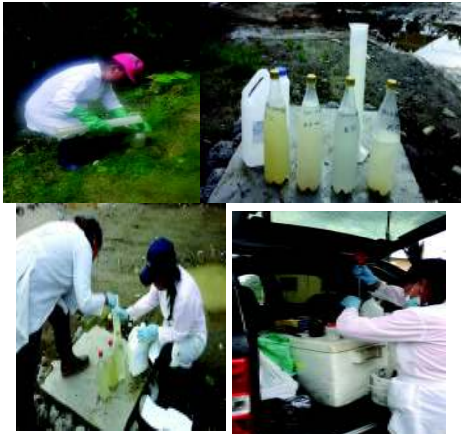
FIGURA 3.5 MUESTREO COMPUESTO DE LAS DESCARGAS DE AGUA RESIDUAL DOMÉSTICA DE LA “ZONA B”, ABRIL 2018.
