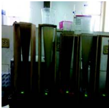
FIGURA 3.6 CONOS IMHOFF CON MUESTRAS DE AGUA RESIDUAL DE LA “ZONA B”, ABRIL 2018.
