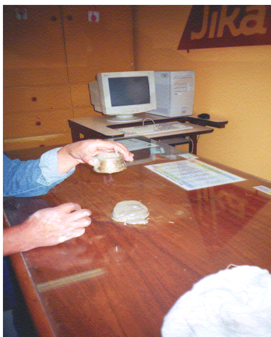
Foto N°15.- Colocado de la mezcla en un cono y con probación de mezcla poco fluida.
