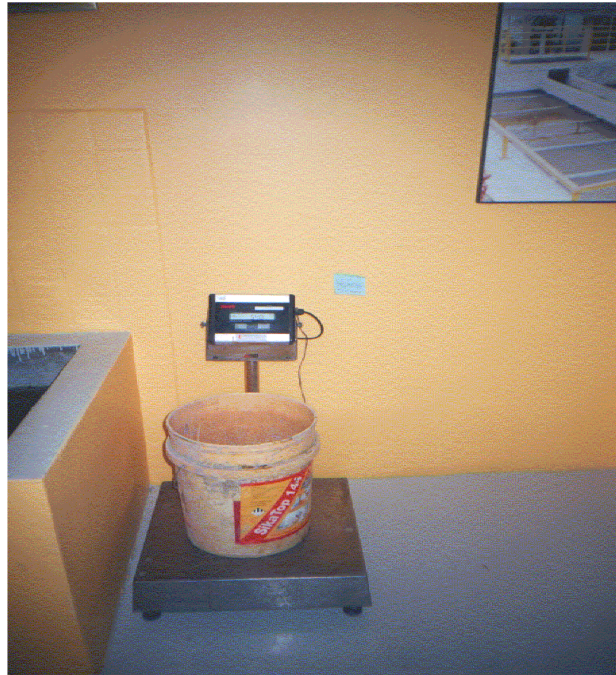
Foto N°5.- Pesar los materiales en sus porcentajes especificados en balanza.
