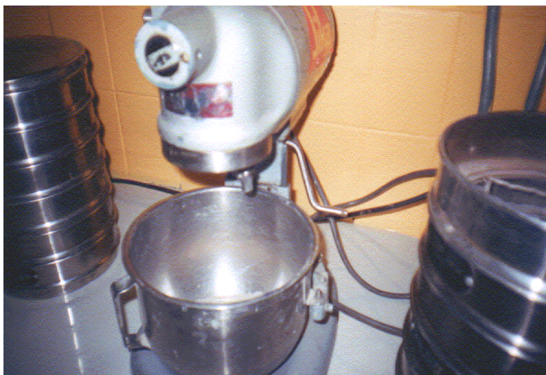
Foto N°12.- Colocado del cemento en la mezcladora o batidora.
