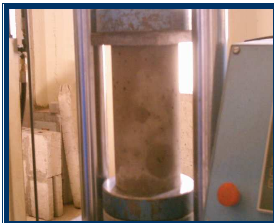
Foto N°1.- Cilindro de hormigón listo para ser ensayado (laboratorio de Ingeniería Civil EPN)
