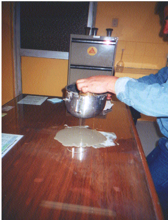
Foto N°16.- Colocado de la mezcla en un cono y com probación de mezcla más fluida.
