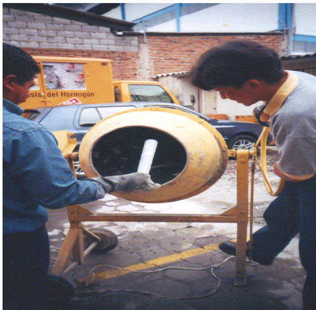
Foto N°7.- Colocado de agua en su porcentaje especificado en mezcla.
