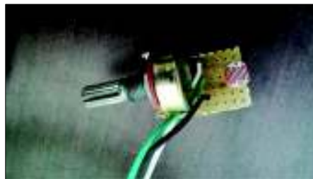
Figura 2.48. Baquelita para el sensor de luminosidad
