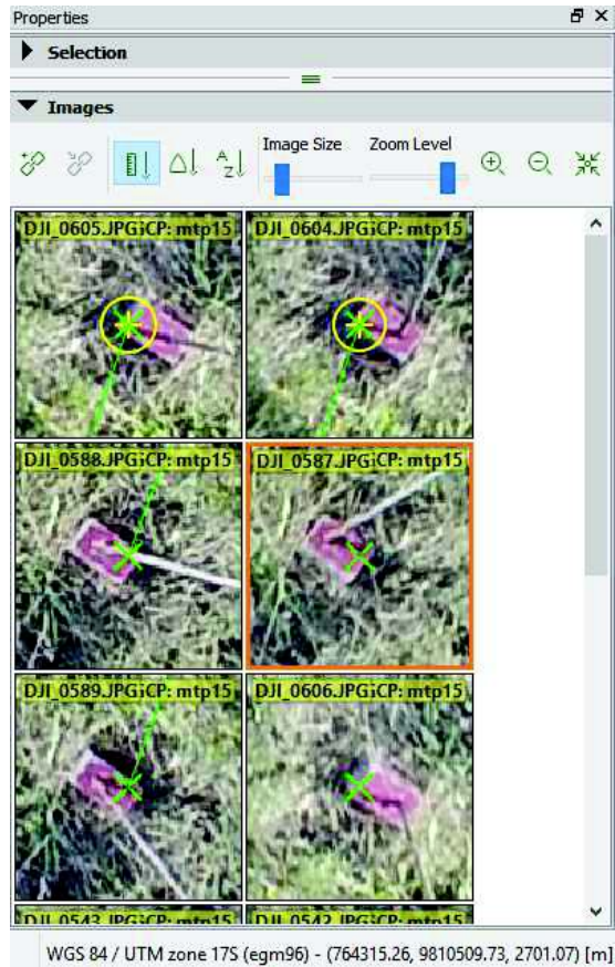
FIGURA 3.56 PUNTOS DE UNIÓN (MTP) EN VÉRTICES DE SUPERFICIES EN PIX4D
