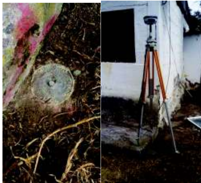
FIGURA 3.6 TOMA DE PUNTO DE CONTROL IGM, HACIENDA PANTAÑO
