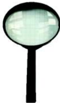
Figura 2.1. Lupa utilizada para la inspección visual. (Fuente: Propia)
