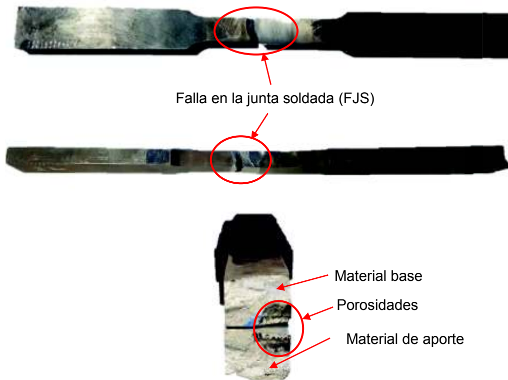
Figura 3.9. Pobreta normalizada para tracción (T2-AI) soldada con M.A. AWS E 312-16. (Fuente: Propia)
