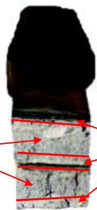
Figura 3.11. Pobreta normalizada para tracción (T2-NI) soldada con M.A. AWS E NiFe-CI. (Fuente: Propia)
