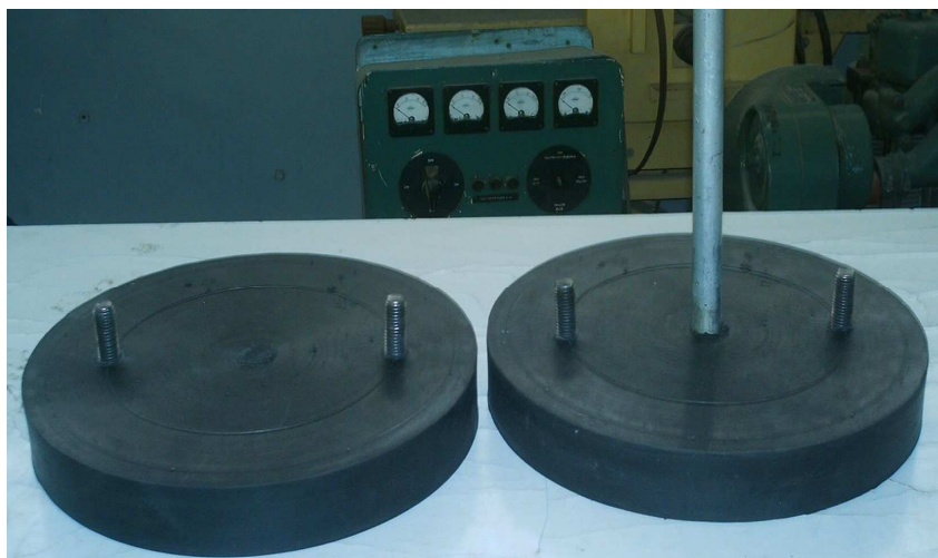
Fig. 3.20 Cauchos selladores terminados
