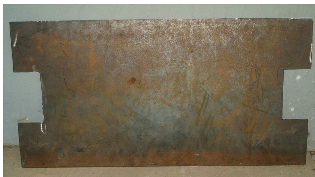
Fig. 3.8 Mesa de soporte para caucho inferior
