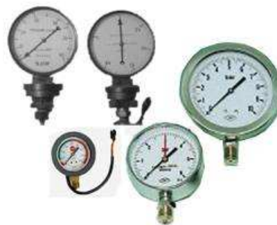
Fig. 2.4 Manómetros tipo bourdon de diferentes escalas.
