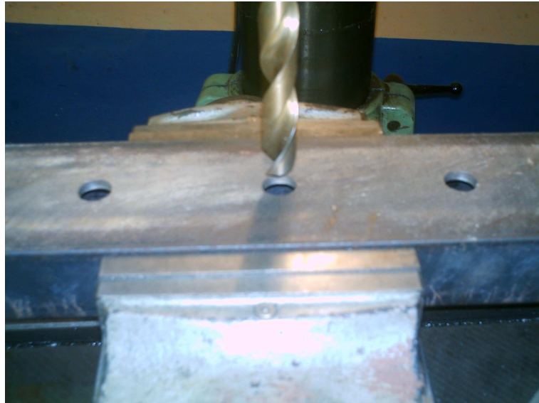
Fig. 3.5 Perforación de la viga superior
