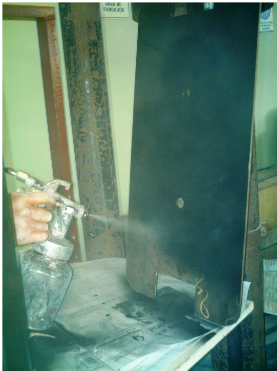
Fig. 3.16 Mesa de soporte en fase de pintura
