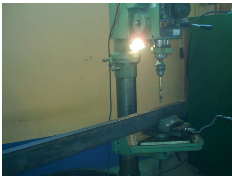
Fig. 3.4 Perforación de columnas verticales
