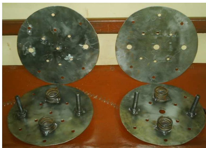
Fig. 3.19 Estructura interna de los cauchos selladores en despiece
