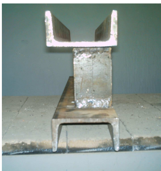
Fig. 3.11 Bancada móvil soldada con electrodo E 7018
