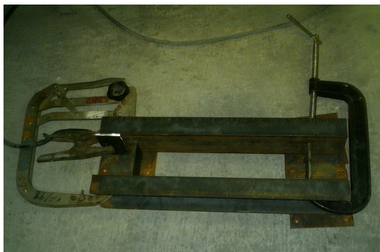
Fig. 3.9 Bancada móvil sujeta con prensas previo a la soldadura
