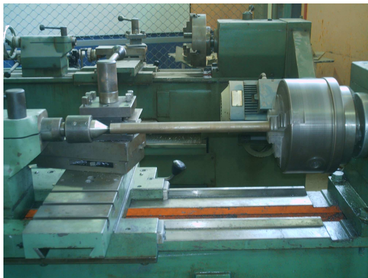
Fig. 3.7 Construcción de pasadores
