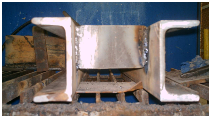
Fig. 3.10 Bancada móvil soldada con electrodo E 6010
