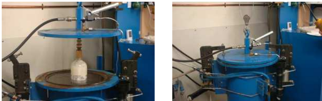
Fig. 2.2 Banco de pruebas hidrostáticas a botellas.
