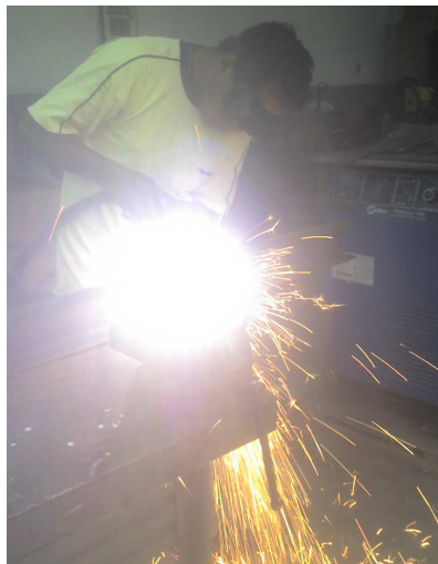
Fig. 3.3 Proceso de corte con plasma
