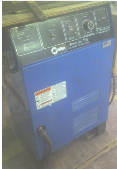
Fig. 3.1 Cortadora de plasma de DC marca "Miller"
