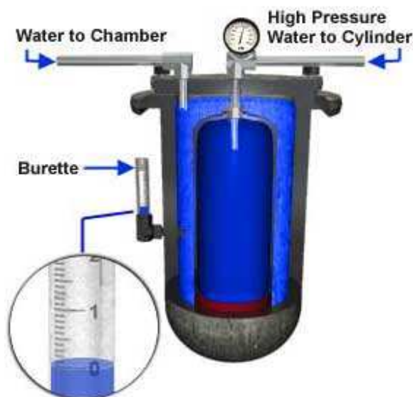
Fig. 2.3 Esquema interno de la prueba hidrostática y medición del líquido desplazado.
