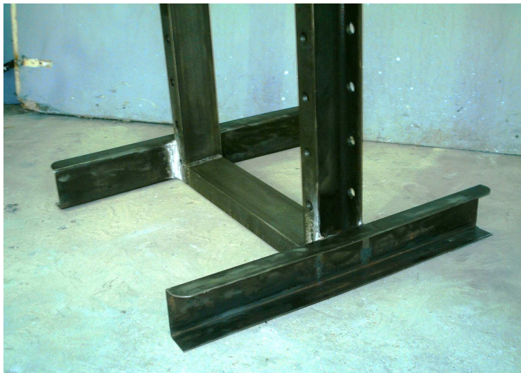
Fig. 3.14 Módulo con perfiles de soporte soldados
