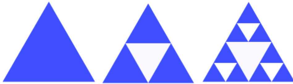
Figura 1.15. Antena basada en la segunda iteración del triángulo de Sierpinski.
