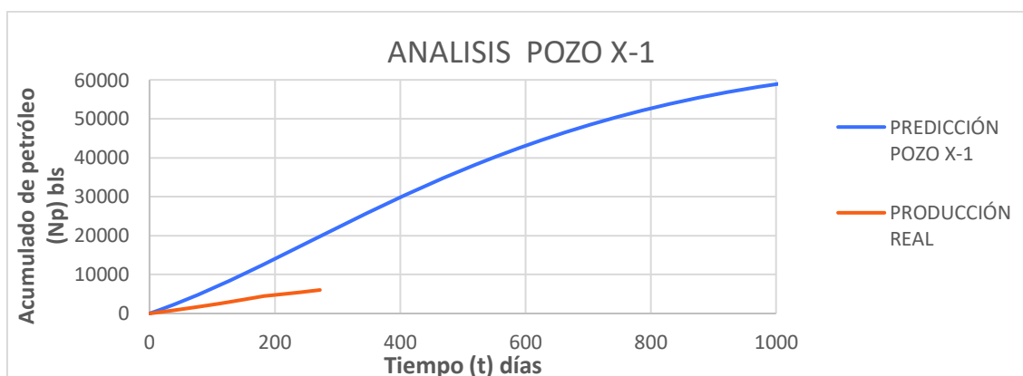
FIGURA 3.22 COMPARACIÓN DEL ACUMULADO DE PETRÓLEO VERSUS TIEMPO PARA DATOS REALES Y PREDICHOS EN EL POZO X-1 USANDO EL MÉTODO DE DYKSTRA – PARSONS.
