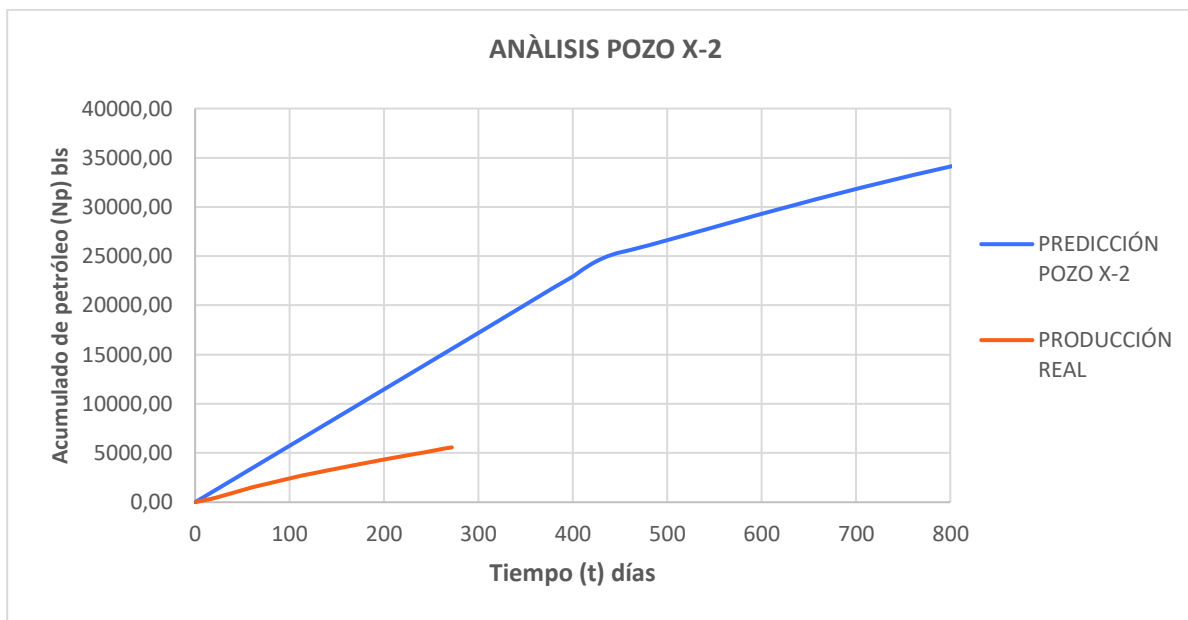
FIGURA 3.17 COMPARACIÓN DEL ACUMULADO DE PETRÓLEO REAL Y PREDICHO EN EL POZO X-2.
