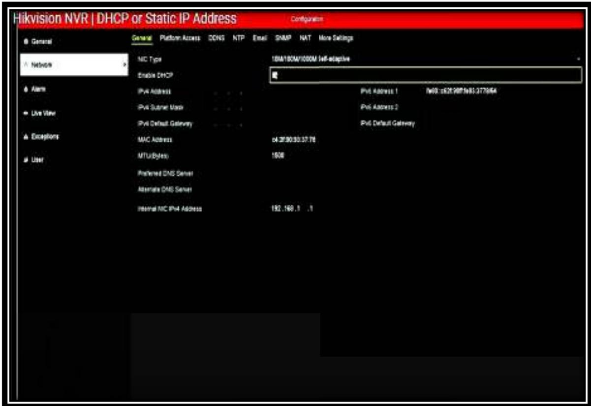
Figura 41: Configuración de red.
