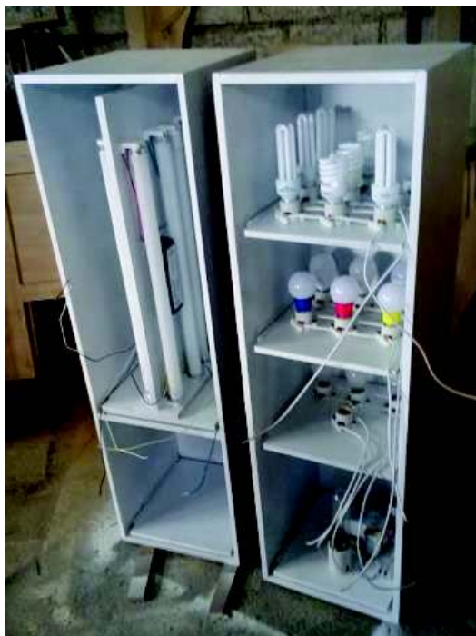
Figura 2.4 Módulos de cargas no lineales en etapa de construcción
