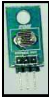
Figura 2.15 Sensor de luz LDR [1]
