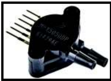
Figura 2.13 Sensor de presión diferencial MPX5050DP [12]
