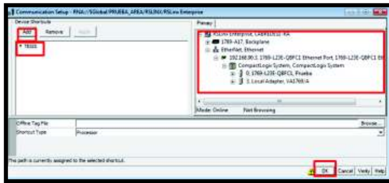
Figura II.34 Adquisición de tags del Módulo PLC
