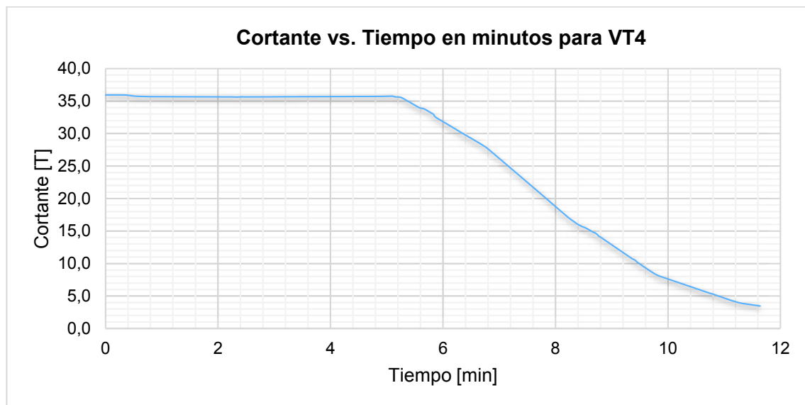
FIGURA 5.22 Degradación del cortante de la viga VT4
