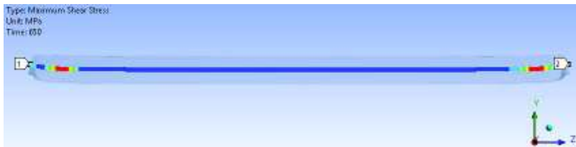
FIGURA 5.31 Distribución de esfuerzos por corte en la viga V4
