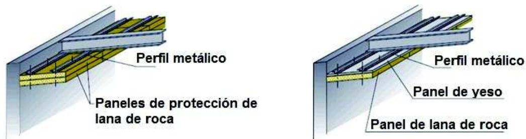
FIGURA 5.42 Sistema de placas de yeso
