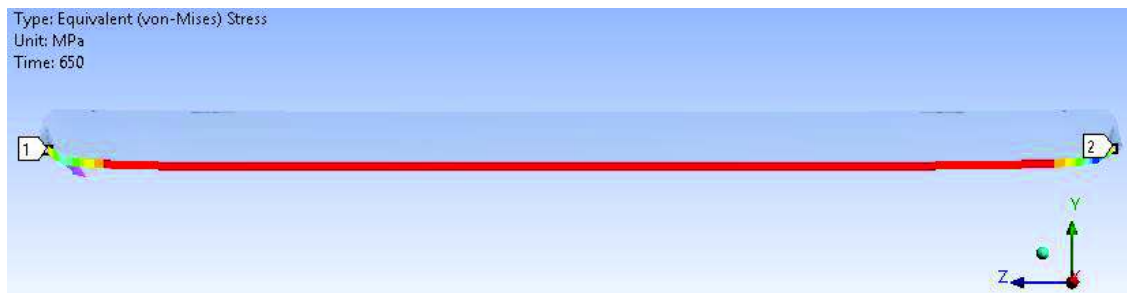
FIGURA 5.33 Distribución de esfuerzos normales por flexión en la viga V4
