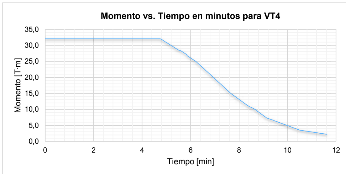
FIGURA 5.24 Degradación del momento de la viga VT4
