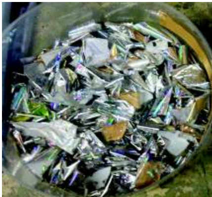
FIGURA 23. LÁMINAS METÁLICAS OBTENIDAS EN LA METODOLOGÍA VINYLOOP (CO1).
