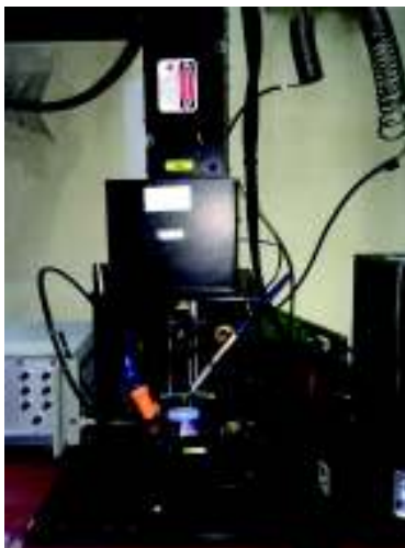
FIGURA 17. ANÁLISIS DE ESPECTROSCOPIA DE RUPTURA POR LÁSER INDUCIDO
