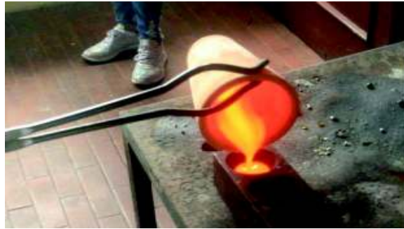
FIGURA 26. MUESTRA COLOCADA EN LA LINGOTERA
