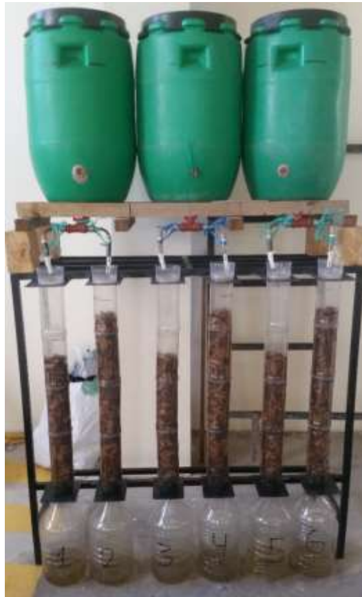
FIGURA 3.7 Sistemas de biofiltración instalados en el laboratorio
