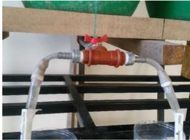
FIGURA 3.6 Conexiones del sistema de biofiltración
