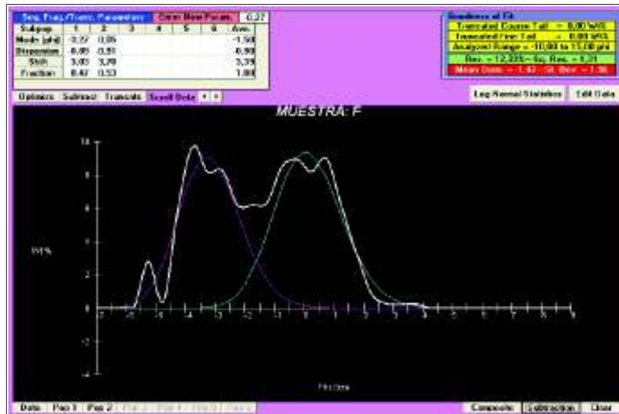
Figura 19. Ventana de análisis de los datos, en donde se grafica la curva de granulometría, la línea blanca representa la distribución de los datos y las líneas morada y turquesa representan la deconvolución realizada por el software.
