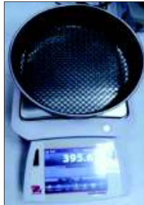
Figura 15. Peso de uno de los tamices vacíos previo a la colocación de la muestra en su interior.
