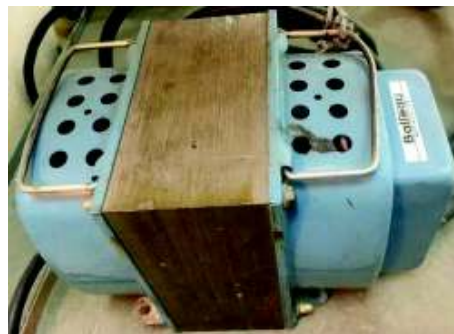
Figura 2.20. Transformador de alta tensión. (Fuente: Propia)
