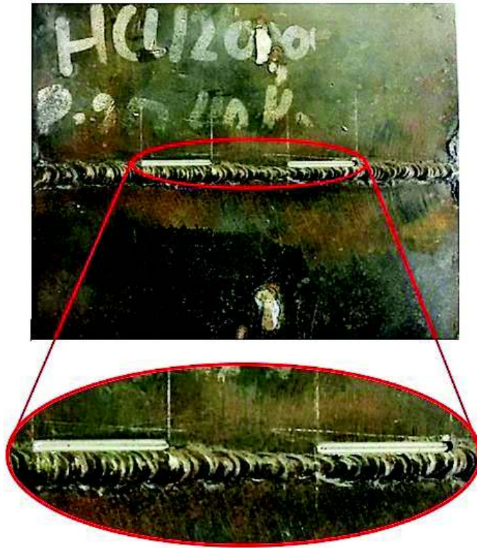
Figura 2.9. Detalle de discontinuidad IU generada en una probeta soldada. (Fuente: Propia)
