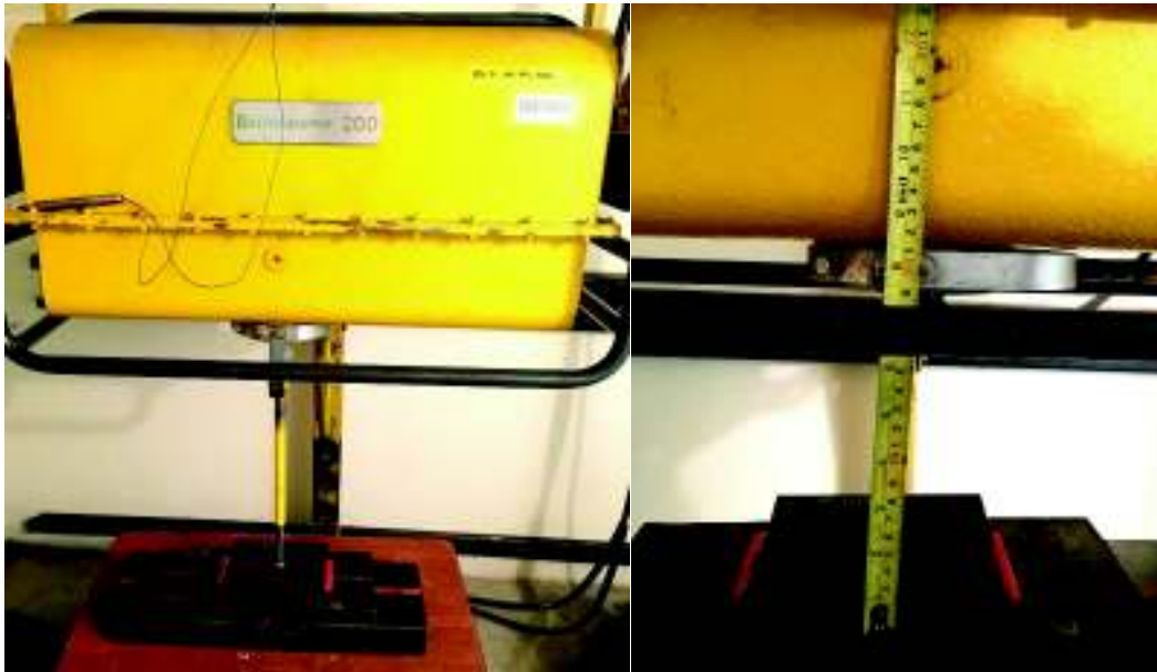
Figura 2.23. Colocación de la probeta y placa radiográfica respecto al punto focal. (Fuente: Propia)
