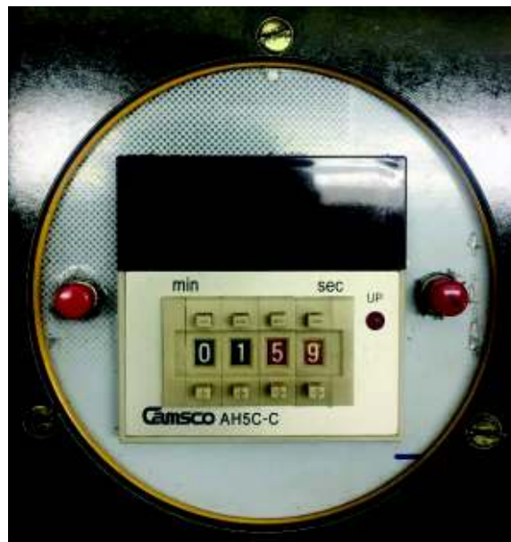
Figura 2.24. Asignación del tiempo de exposición en el panel de control. (Fuente: Propia)
