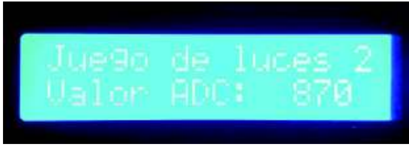
Figura 3. 22 Mensaje del segundo juego de luces y valor del potenciómetro
