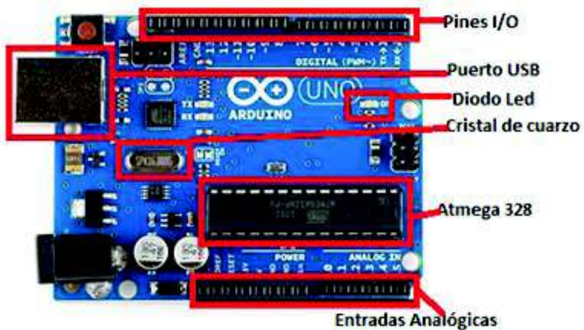
Figura 1. 1 Partes del módulo Arduino Uno [5]
