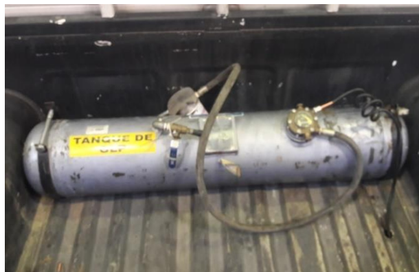
Figura 2.8. Tanque de almacenamiento de GLP. (Fuente: Propia)
