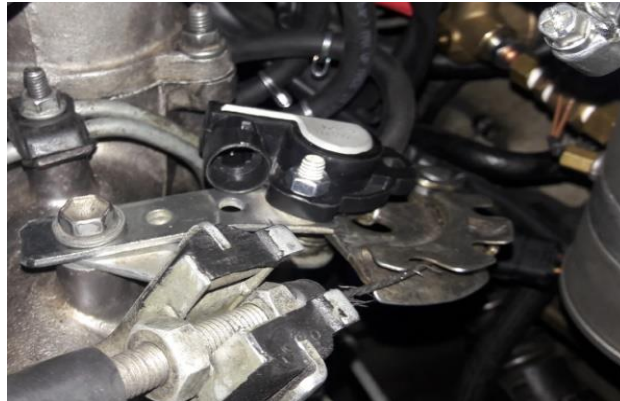
Figura 2.13. Sensor de posición de la aleta de aceleración. (Fuente: Propia)
