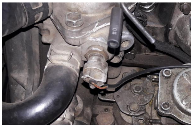
Figura 2.14. Sensor de temperatura del motor. (Fuente: Propia)
