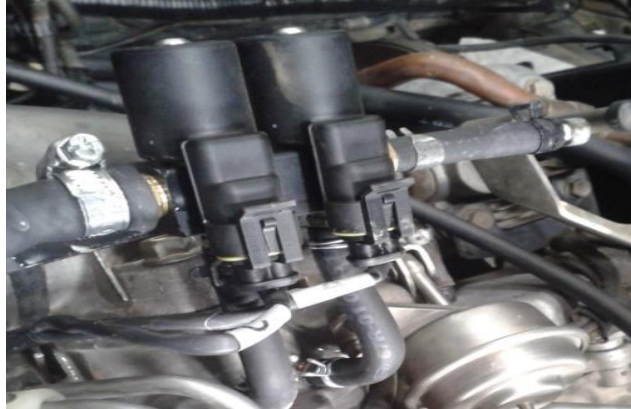
Figura 2.5. Riel de dos inyectores. (Fuente: Propia)
