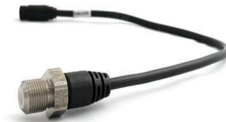
Figura 2.12. Sensor de temperatura de los gases de escape. (Fuente: Propia)
