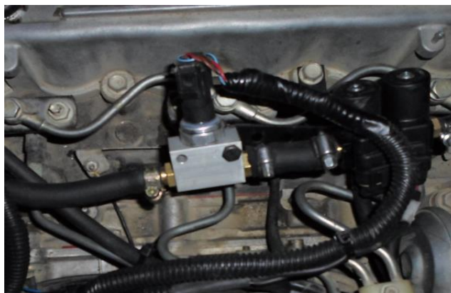
Figura 2.6. Sensor de temperatura y presión del riel de inyectores. (Fuente: Propia)
