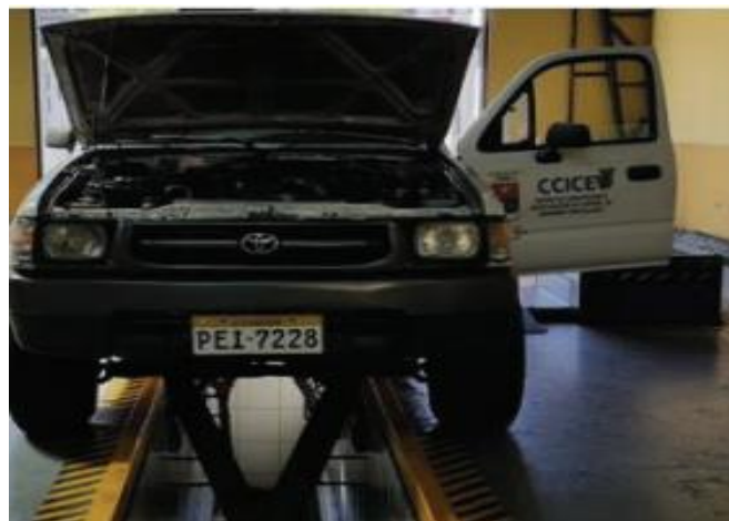
Figura 2.20. Fijación del vehículo en el dinamómetro. (Fuente: Propia)
