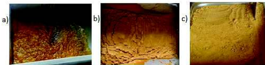
Figura 1.3. Etapas del proceso de pulverizado: (a) líquida, (b) transición y (c) sólida. (Fuente: Propia)
