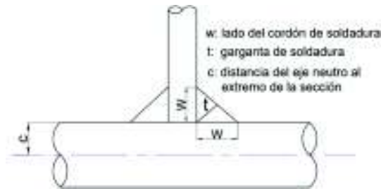
Figura 1.22. Esquema de la junta soldada. (Fuente: Propia)
