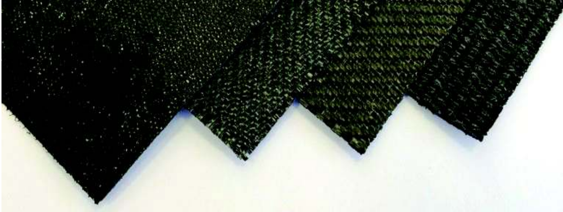
Figura 4.8 Ejemplo de geotextiles tejidos con fibras sintéticas. Tomado del sitio web Maccaferri.
