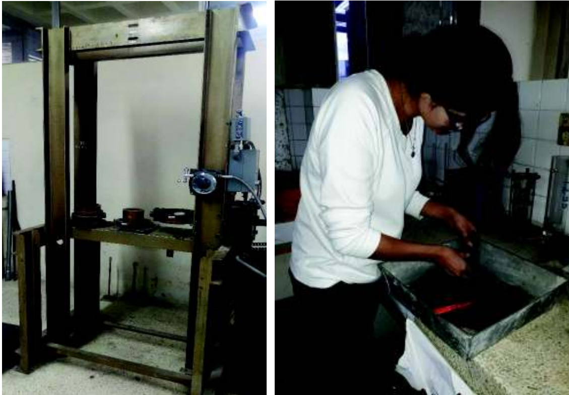
Fotografía 3.3 Maquina con la que se realiza los ensayos de corte directo (figura de la izquierda). Preparación de las muestras para realizar ensayo de corte directo (figura de la derecha).
