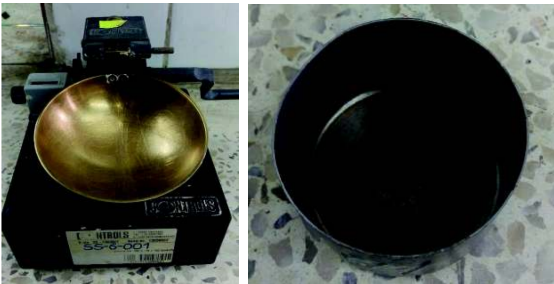
Fotografía 3.5 Cuchara de Casagrande utilizada para realizar el ensayo de límite líquido. (figura de la izquierda). Porción de suelo tomada para realizar el ensayo (figura de la derecha).
