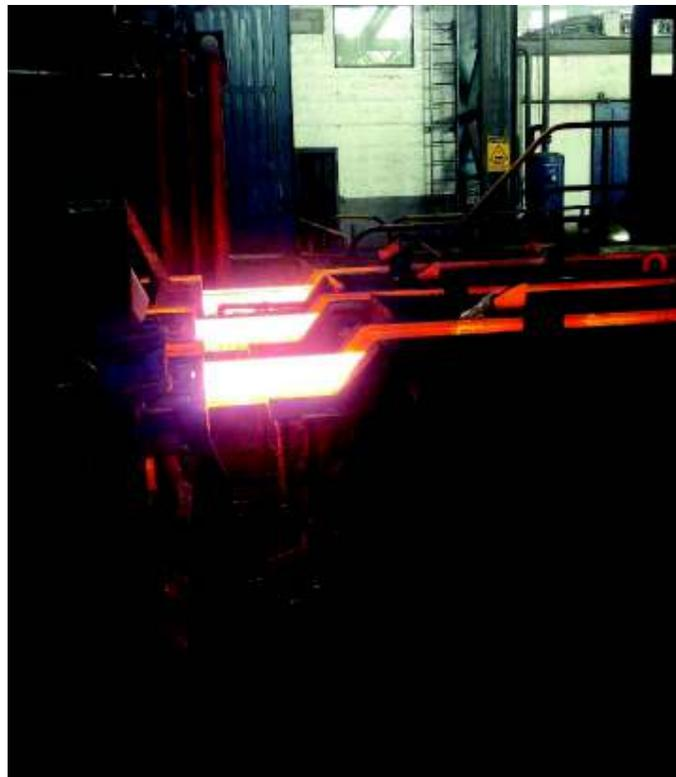
**Figura 2.4** Palanquillas obtenidas a partir de la colada continua.
