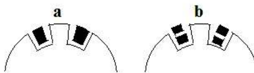
Figura 1.20 (a) bobinado de una sola capa (b) bobinado de dos capas
