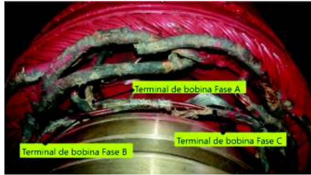
Figura 2.14 Identificación del neutro para la configuración Y
