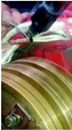
Figura 2.17 Proceso de soldadura con caufín y estaño
