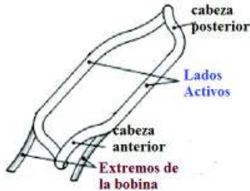
Figura 1.19 Composición básica de un bobinado [7]
