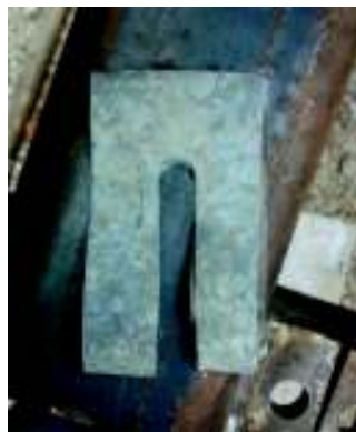
Figura 3.4 Modelo de láminas usadas para levantar el generador sincrónico
