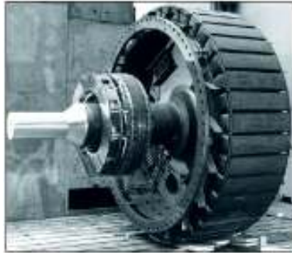
Figura 1.32 Rotor de una máquina síncrona con excitador sin escobillas [4]
