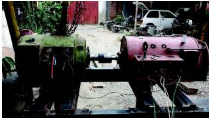
Figura 3.8 Acoplamiento mecánico-incluida alineación y bridas
