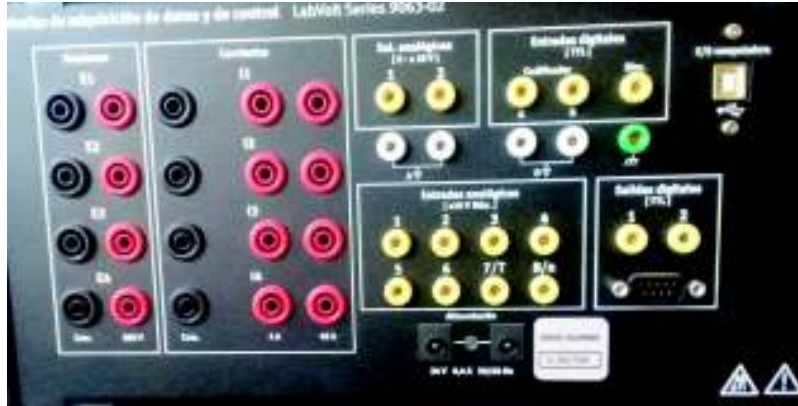
Figura A8.1 Interfaz de adquisición de datos
