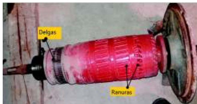
Figura 2.35 Partes del colector del motor DC
