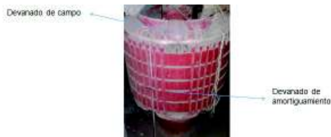
Figura 1.29 Rotor de polos salientes con devanados de amortiguamiento
