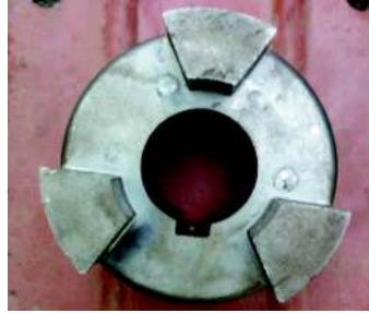
Figura 3.7 Torneado final de una de las bridas
