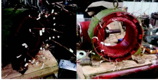
Figura 2.26 Separación de los puntos de suelda de cada bobina
