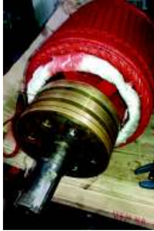
Figura 2.19 Aislamiento con fibra de vidrio
