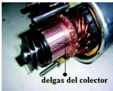
Figura 1.5 Colector de una máquina de corriente continua
