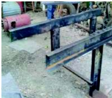
Figura 3.2. Chasis terminado dispuesto para el montaje del grupo motor-generator
