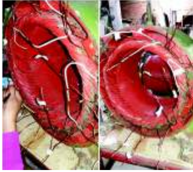
Figura 2.31 Conexión en Y de los bobinados
