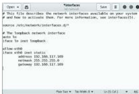
**Figura 2.20.** Configuración de red del equipo Kali Linux.
