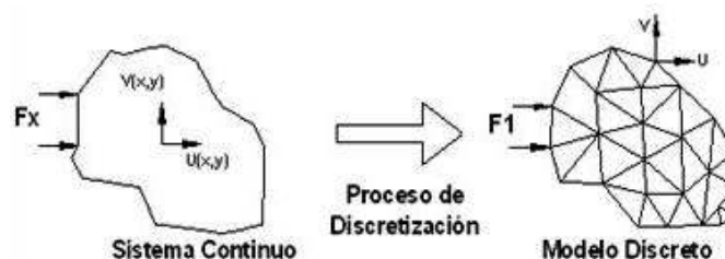
Figura 1.23. Esquema del proceso de discretización de un sistema o medio continuo. (Fuente: [40])
