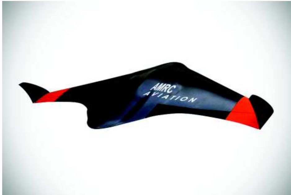
Figura 2.14. Estructura del “Razor” fabricado en ABS mediante impresión 3D. (Fuente: [47])
