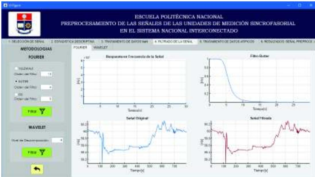
**Figura 4.17.** Sección 4: Filtrado de la señal
