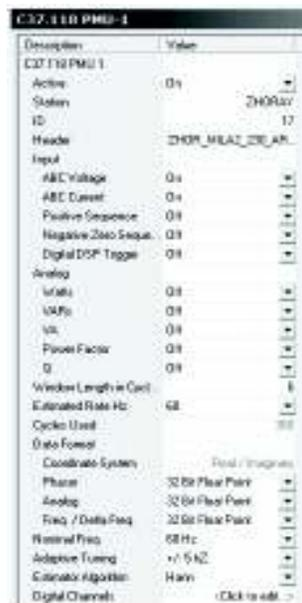
Figura 2.5. Configuración de la PMU ZHORAY - MILAGRO 2 [12]
