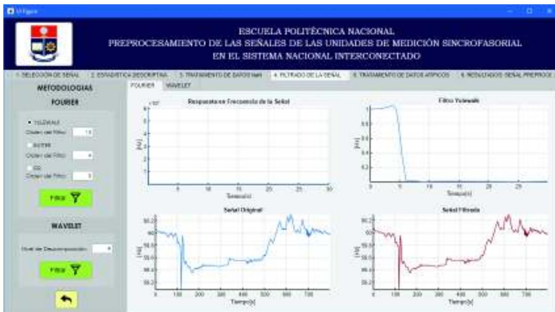
**Figura 4.16.** Sección 4: Filtrado de la señal
