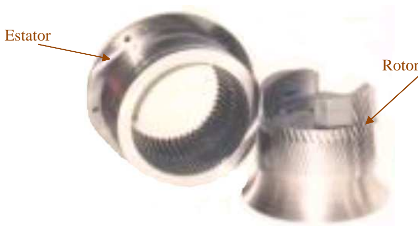
Figura 7. Rotor y estator cónicos, con ranuras en la periferia
