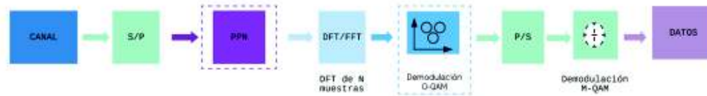
Figura 1.20. Diagrama de bloques del receptor FBMC con red polisafe.
