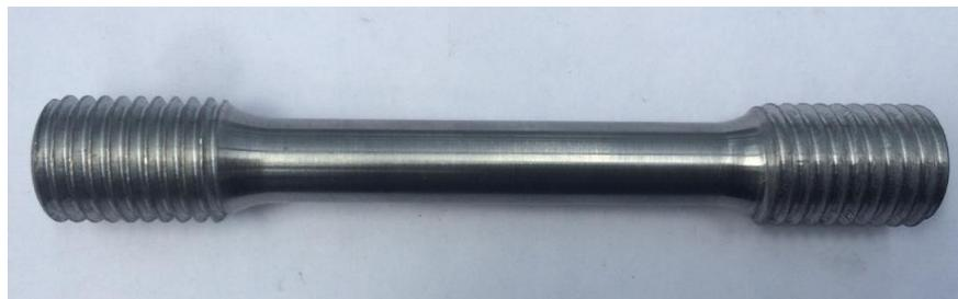
Figura 2.10. Probeta maquinada para el ensayo de tracción del material base.
