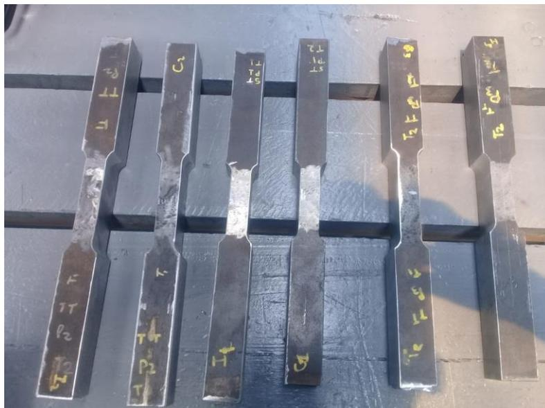
Figura 2.13. Probetas maquinadas para el ensayo de tracción.
