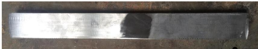
Figura 2.16. Probetas maquinadas para el ensayo de doblado lateral.
