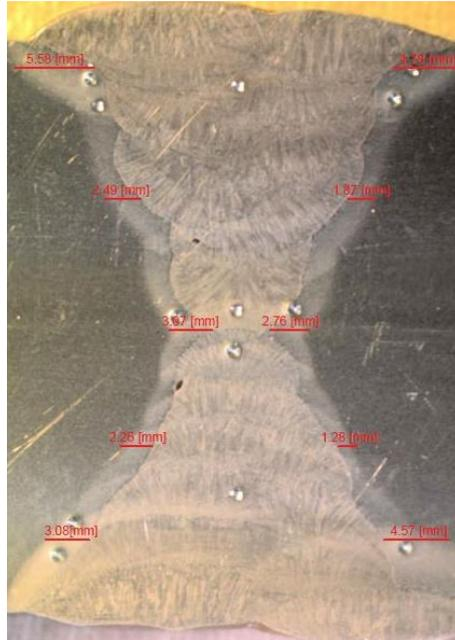
Figura 3.2. Macrografía probeta sin tratamiento térmico (ST) (Magnificación 0,4X).
