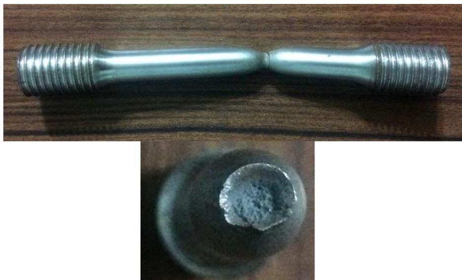
Figura 3.1. Probeta ensayada del Metal Base y sección transversal.
