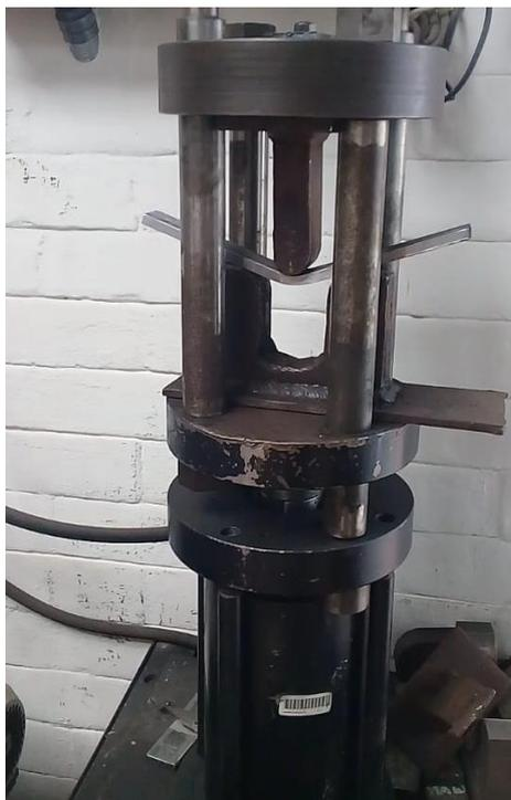
Figura 2.17. Realización del ensayo de doblado.
