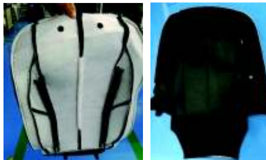
Figura 2.3. Forro espaldar y forro base. (Fuente: propia)
