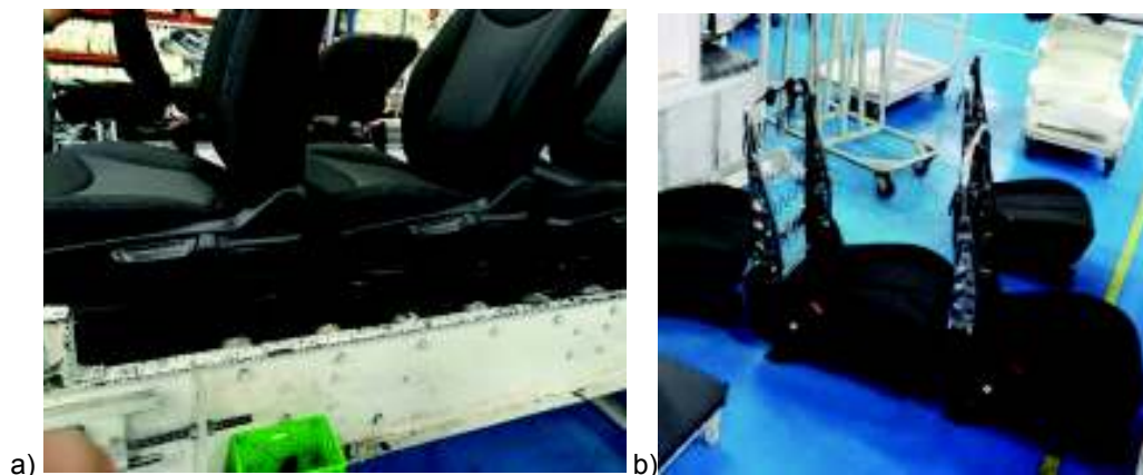
Figura 2.7. Cuellos de botella a) Cuellos de botella en banda transportadora; b) Asientos en el piso, sobreproducción. (Fuente: propia)
