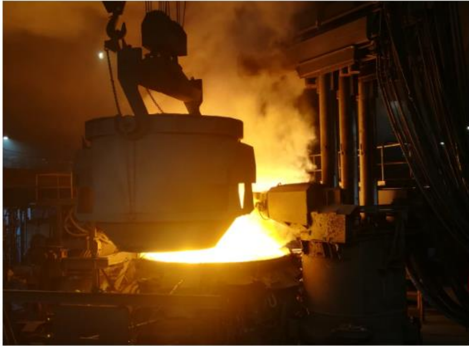
Figura 2.19. Etapa de carga de chatarra en el horno. (Fuente: Planta Industrial Adelca, 2018.)
