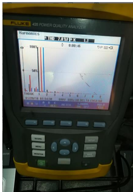
Figura 1.19. Analizador de energía Fluke 435
